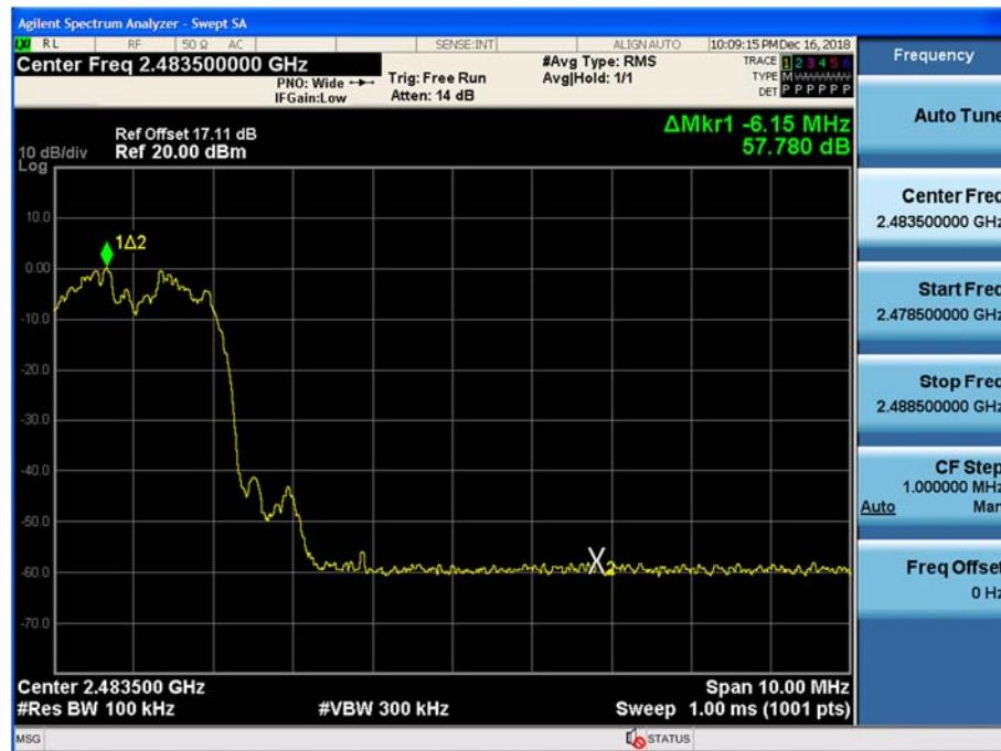
Test Plots with hopping ( $\pi/4$ DQPSK)
