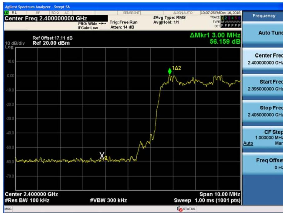
Test Plots with hopping ( $\pi/4$ DQPSK)
