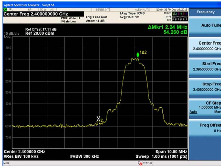
Test Plots without hopping ( $\pi/4$ DQPSK)
