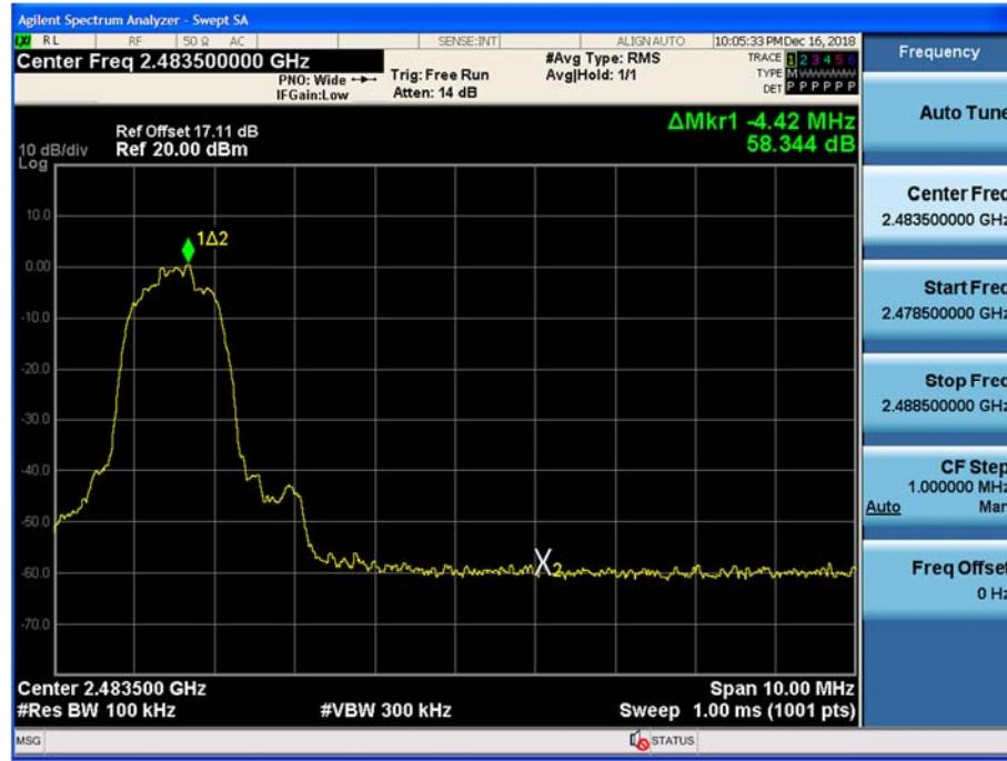
Test Plots without hopping ( $\pi/4$ DQPSK)
