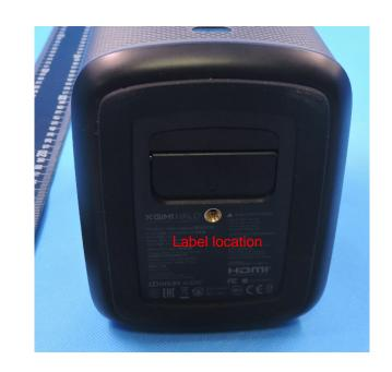
材质: 磨砂PC+背胶 颜色: 黑底, 印刷Pantone cool gray 9C 公差: ±0.1mm
