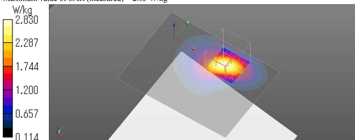
**UHF-RFID Edge 3 tilt Mid ch Duty 100%**
