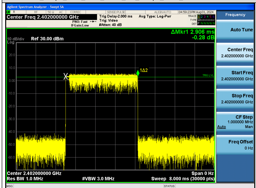
Test_Graph_EDR_HOP_ANT1_NA_3Mbps_2402_Time per Burst
