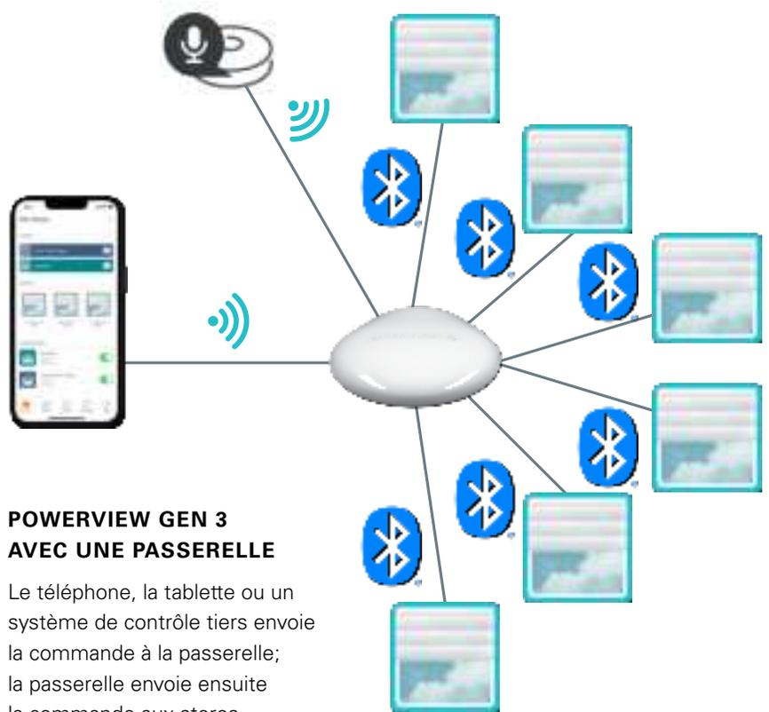
Le téléphone, la tablette ou un système de contrôle tiers envoie la commande à la passerelle; la passerelle envoie ensuite la commande aux stores.
