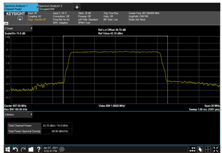
Figure 51: 256QAM 10MHz B.W.; 867.0MHz, 30kHz
