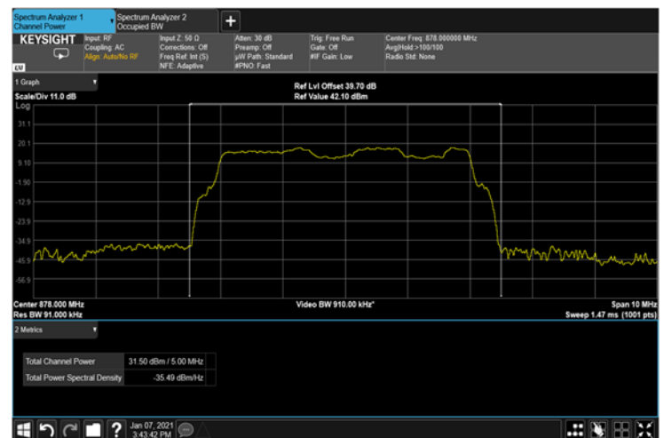
Figure 11: 16QAM 5MHz B.W.; 878.0MHz, 30kHz
