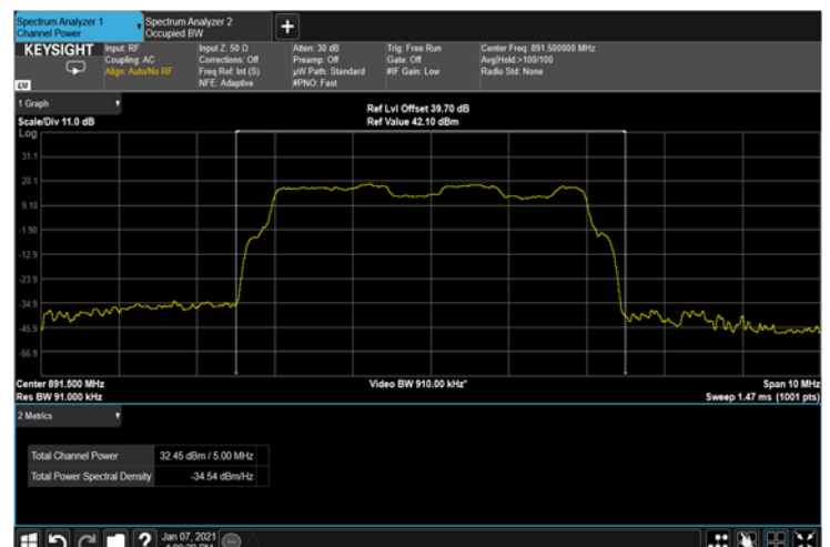
Figure 13: 16QAM 5MHz B.W.; 891.5MHz, 30kHz
