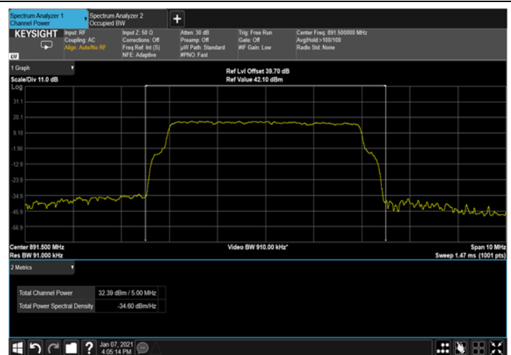
Figure 49: 256QAM 5MHz B.W.; 891.5MHz, 30kHz
