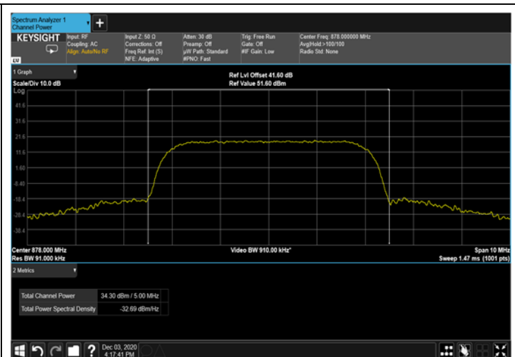
Figure 81: WCDMA 5MHz B.W.; 878.0MHz – 3G
