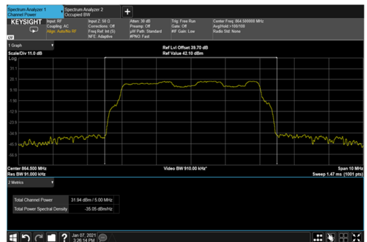
Figure 9: 16QAM 5MHz B.W.; 864.5MHz, 30kHz
