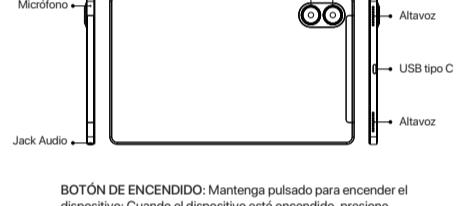
**BOTÓN DE ENCENDIDO:** Mantenga pulsado para encender el dispositivo; Cuando el dispositivo esté encendido, presione brevemente el botón de encendido para apagar o encender la pantalla.
