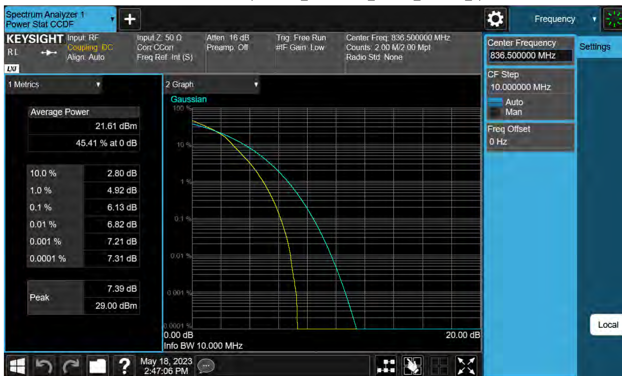
Sub6 n5. PAR Plot (10 M BW_Ch. 167300_16QAM_Full RB_0)
