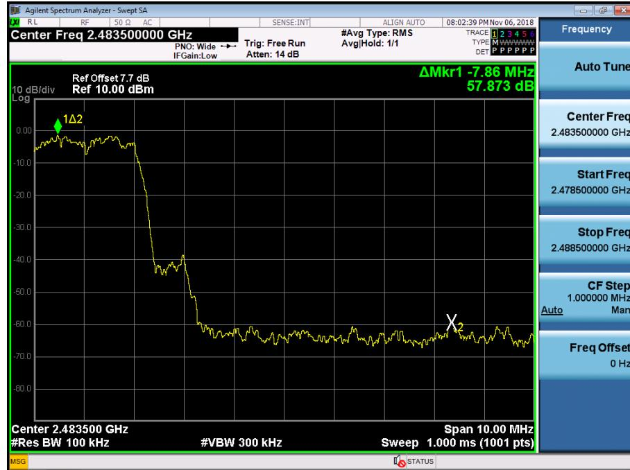
Test Plots with hopping ( $\pi/4$ DQPSK)
