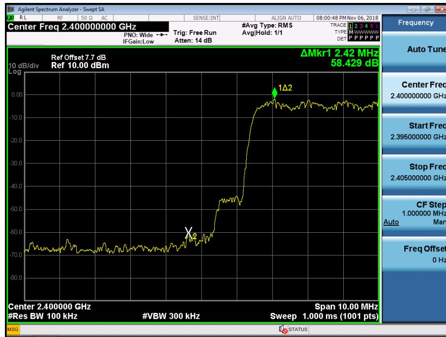
Test Plots with hopping ( $\pi/4$ DQPSK)
