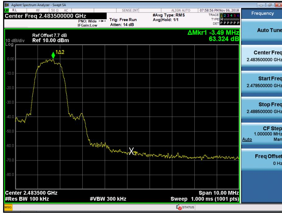
Test Plots without hopping ( $\pi/4$ DQPSK)
