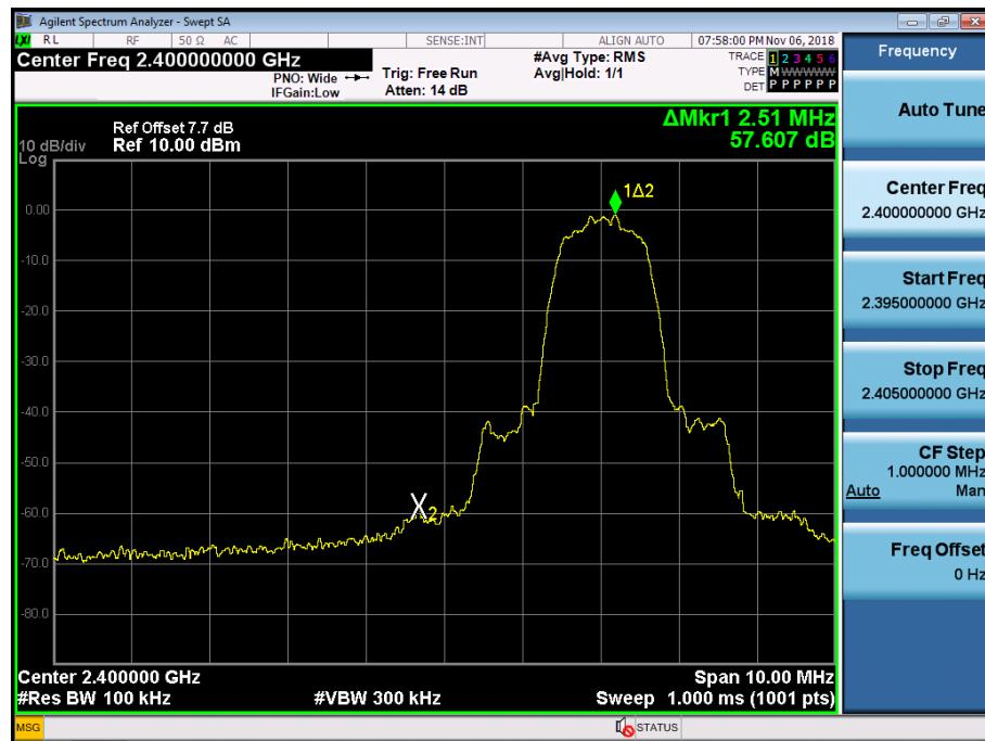
Test Plots without hopping ( $\pi/4$ DQPSK)
