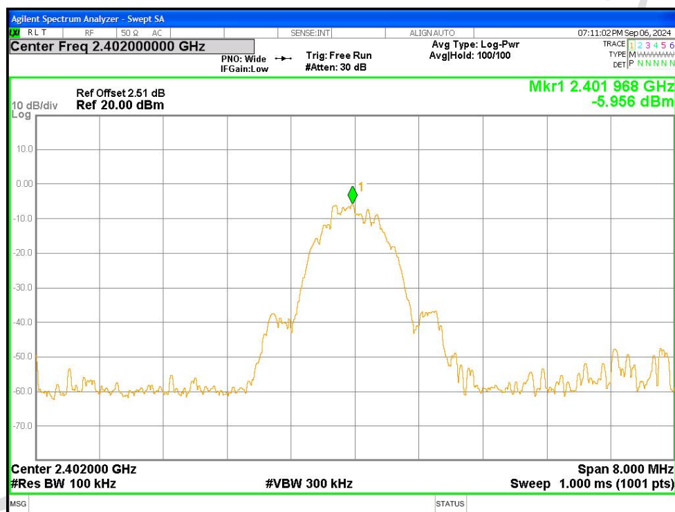
Band Edge NVNT BLE 1M 2402MHz Ant1 Emission
