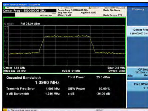
Band2 / 1.4MHz / Mid CH / 16QAM
