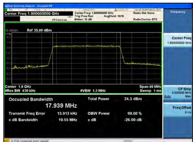
Band2 / 20MHz / High CH / 64QAM
