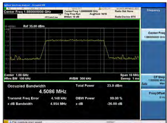
Band2 / 5MHz / Mid CH / 64QAM
