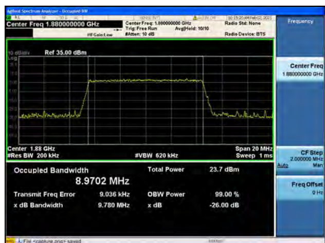
Band2 / 10MHz / High CH / 16QAM
