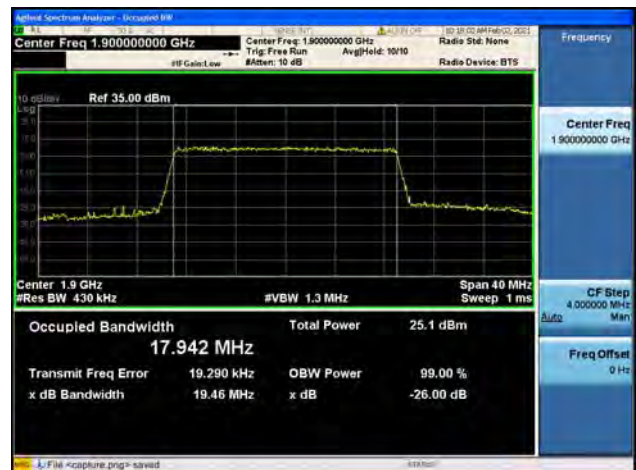
Band2 / 20MHz / High CH / 64QAM
