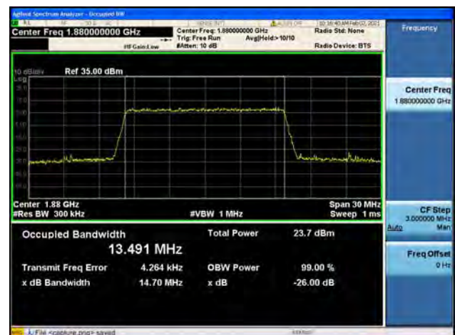
Band2 / 15MHz / Mid CH / 64QAM
