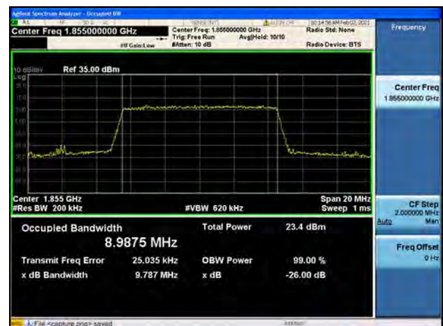
Band2 / 10MHz / Low CH / 64QAM
