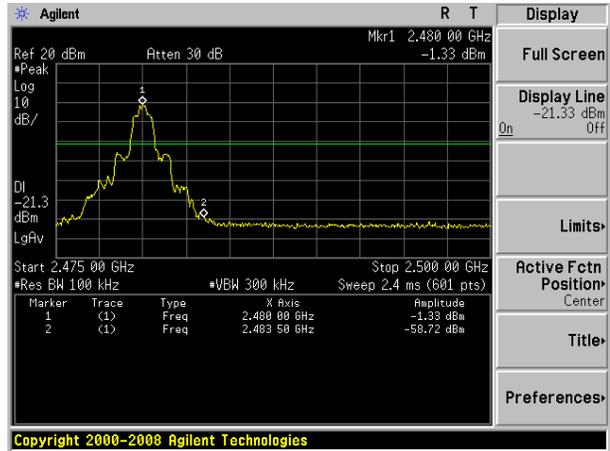
$\pi$  /4-DQPSK: Band Edge-Low Channel
