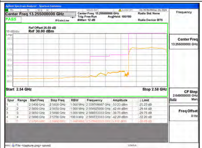
B38 / 10MHz / Low CH / QPSK / FULL RB
