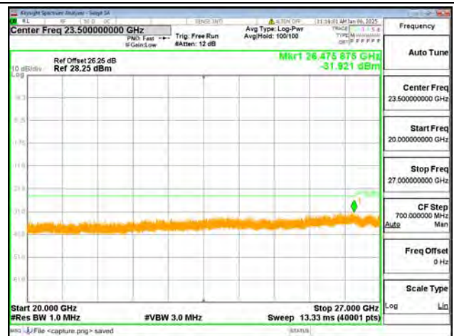
B38-20G-27G / 15MHz / High CH / QPSK
