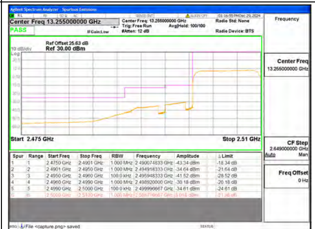
B7 / 10MHz / Low CH / QPSK / FULL RB
