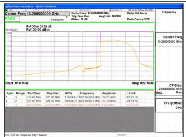
B5 / 1.4MHz / Low CH / QPSK / FULL RB
