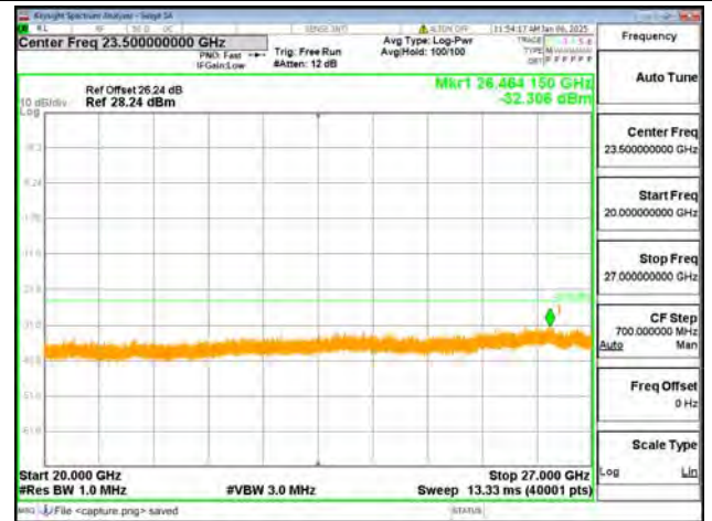
B41-20G-27G / 20MHz / Mid CH / QPSK
