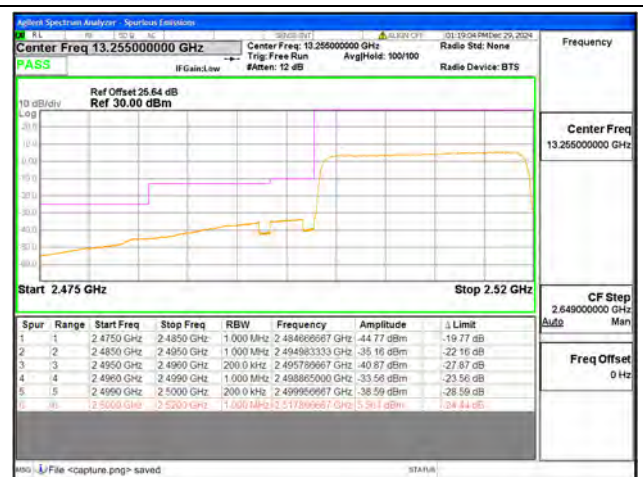
B7 / 20MHz / Low CH / QPSK / FULL RB
