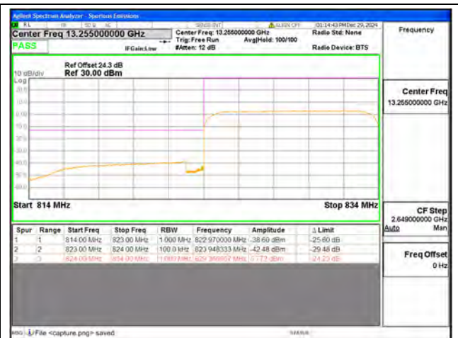
B5 / 10MHz / Low CH / QPSK / FULL RB
