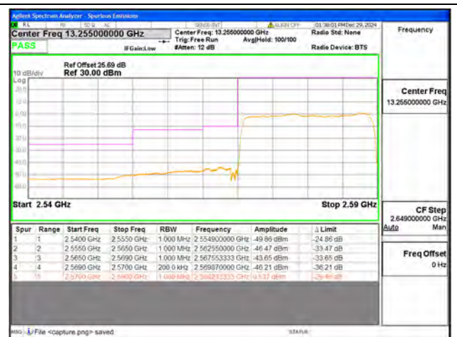
B38 / 20MHz / Low CH / QPSK / FULL RB
