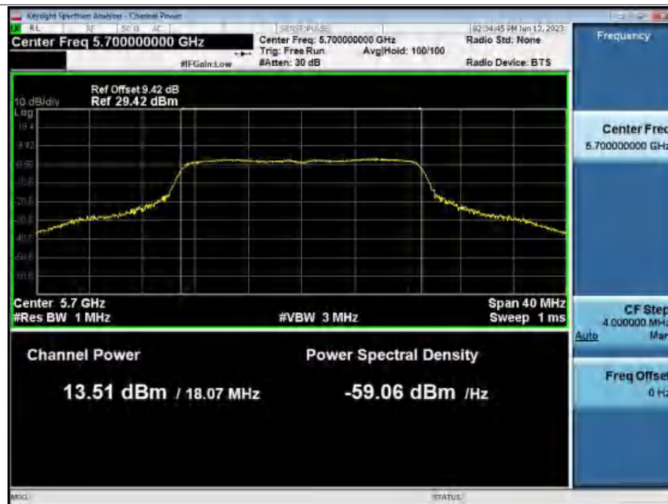
Power NVNT n20 5700MHz Ant1
