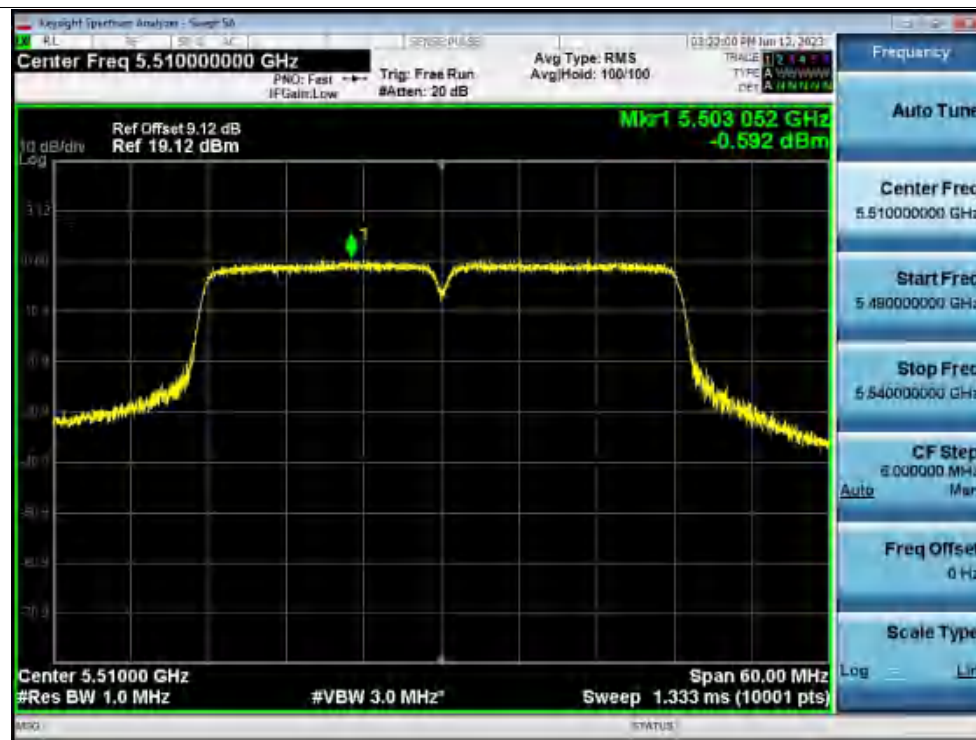
PSD NVNT ac40 5510MHz Ant1
