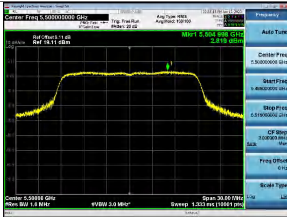
PSD NVNT ac20 5500MHz Ant1
