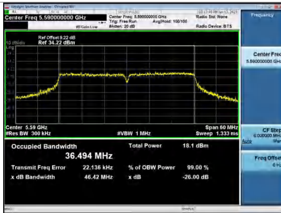
-26dB Bandwidth NVNT n40 5590MHz Ant1
