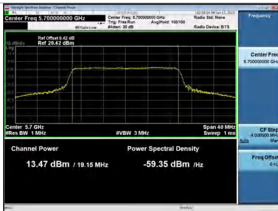
Power NVNT ax20 5700MHz Ant1
