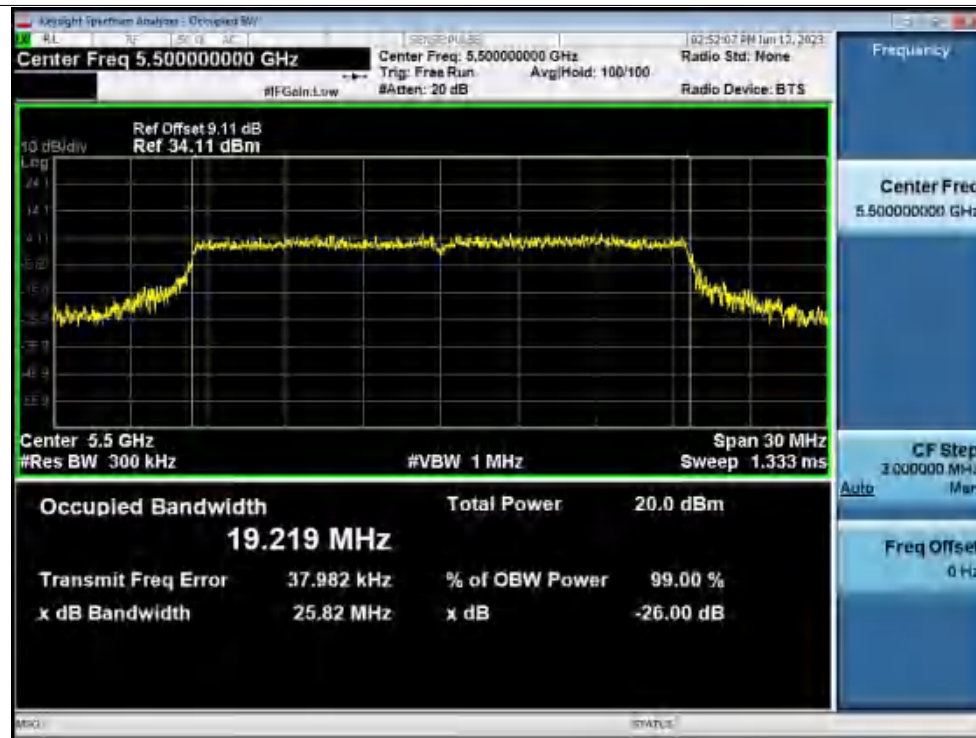
-26dB Bandwidth NVNT ax20 5700MHz Ant1
