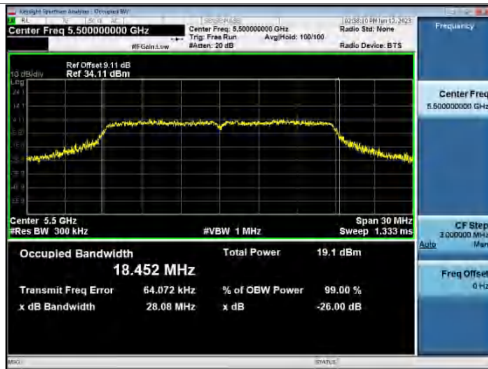
-26dB Bandwidth NVNT ac20 5500MHz Ant1
