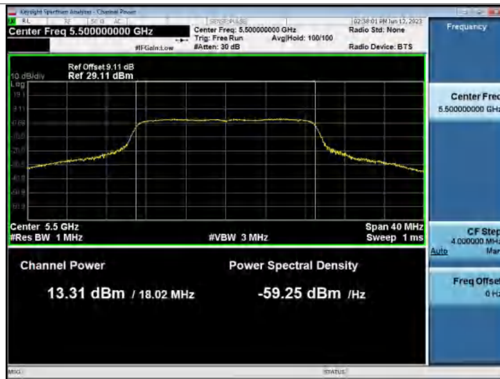
Power NVNT ac20 5500MHz Ant1
