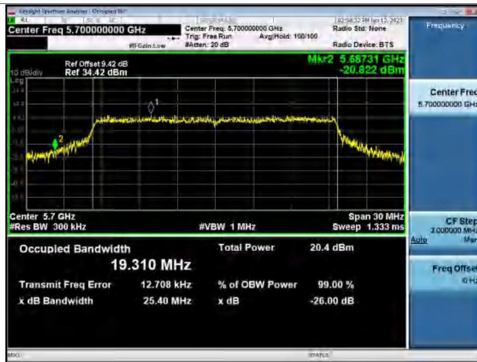
-26dB Bandwidth NVNT ax20 5700MHz Ant1
