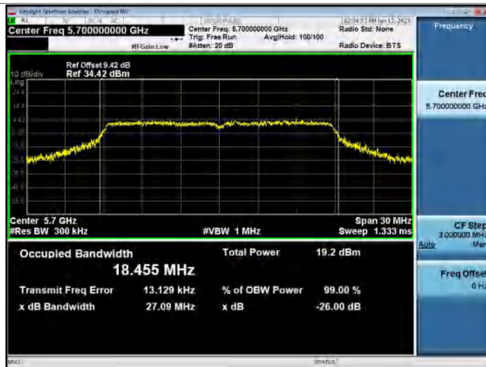
-26dB Bandwidth NVNT n20 5700MHz Ant1
