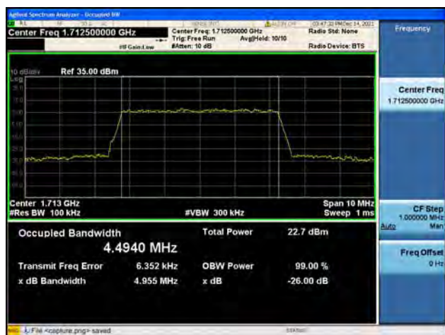
Band66 / 5MHz / Mid CH / QPSK
