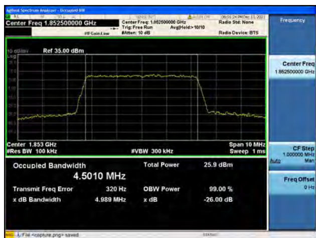
Band2 / 5MHz / Mid CH / QPSK
