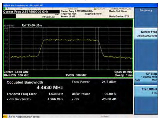
Band7 / 10MHz / Low CH / 16QAM
