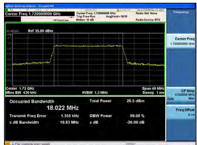
Band4 / 20MHz / Low CH / 64QAM
