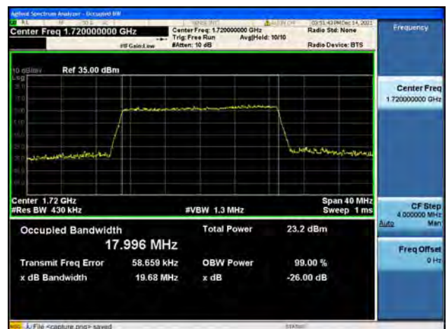
Band66 / 20MHz / Low CH / 64QAM
