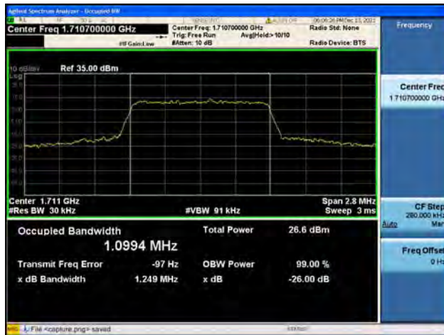
Band4 / 1.4MHz / Low CH / 64QAM
