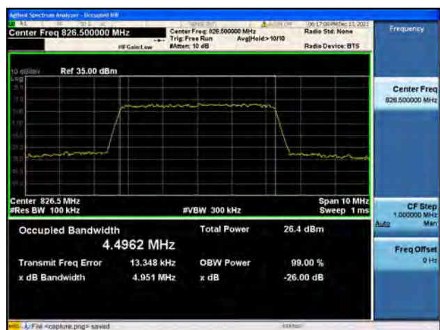
Band5 / 5MHz / Mid CH / 16QAM
