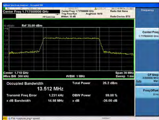
Band4 / 15MHz / Mid CH / QPSK
