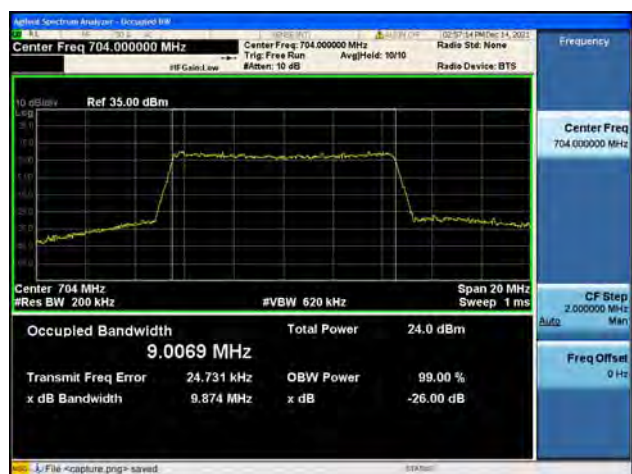
Band12 / 10MHz / Low CH / 16QAM
