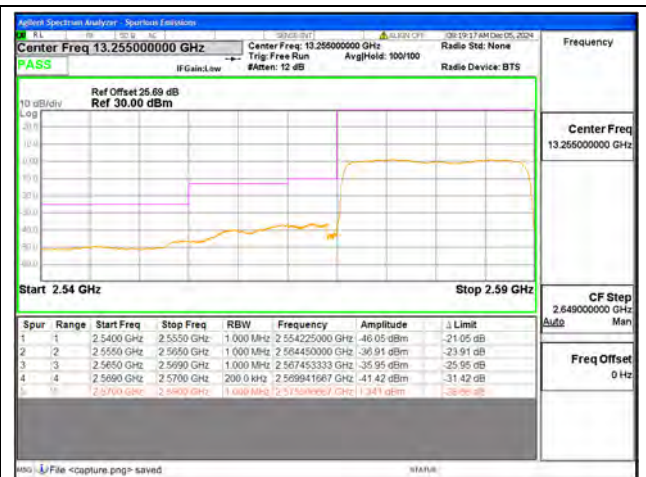
B38 / 20MHz / Low CH / QPSK / FULL RB
