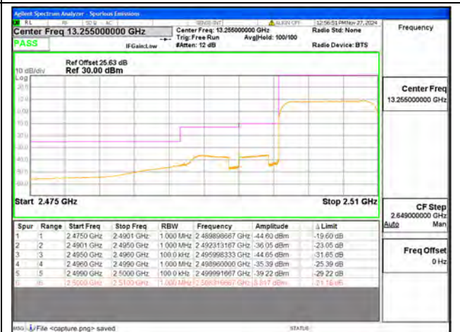
B7 / 10MHz / Low CH / QPSK / FULL RB
