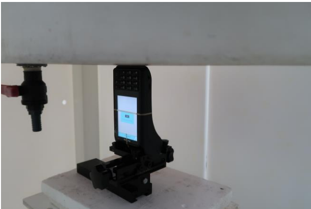
Edge 3, Test Separation 0 mm
