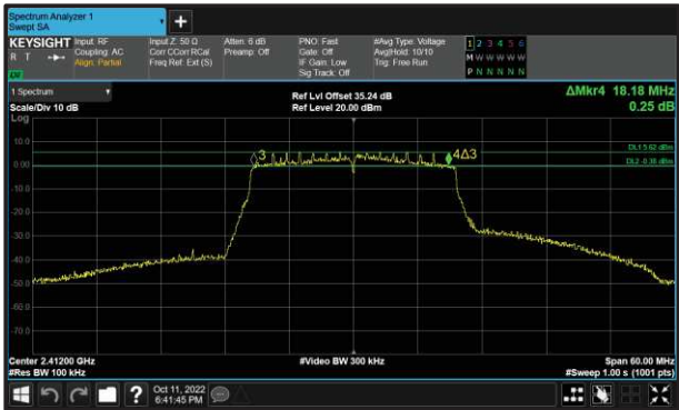
Figure 37 - 802.11ax HE20 SU Minimum 6 dB EBW
