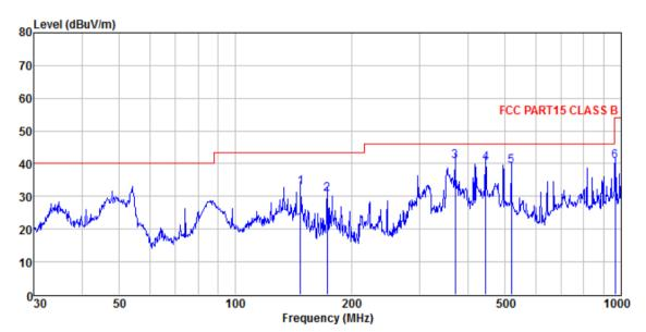
: FCC PART15 CLASS B VULB9163-2013M VERTICAL : Burning test mode
