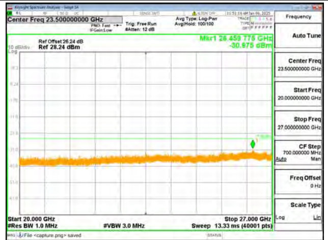
B41-20G-27G / 15MHz / Mid CH / QPSK
