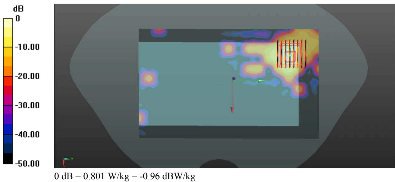
**51\_WLAN5.8GHz\_802.11a 6Mbps\_Back\_10mm\_Ch165\_Ant 2**
