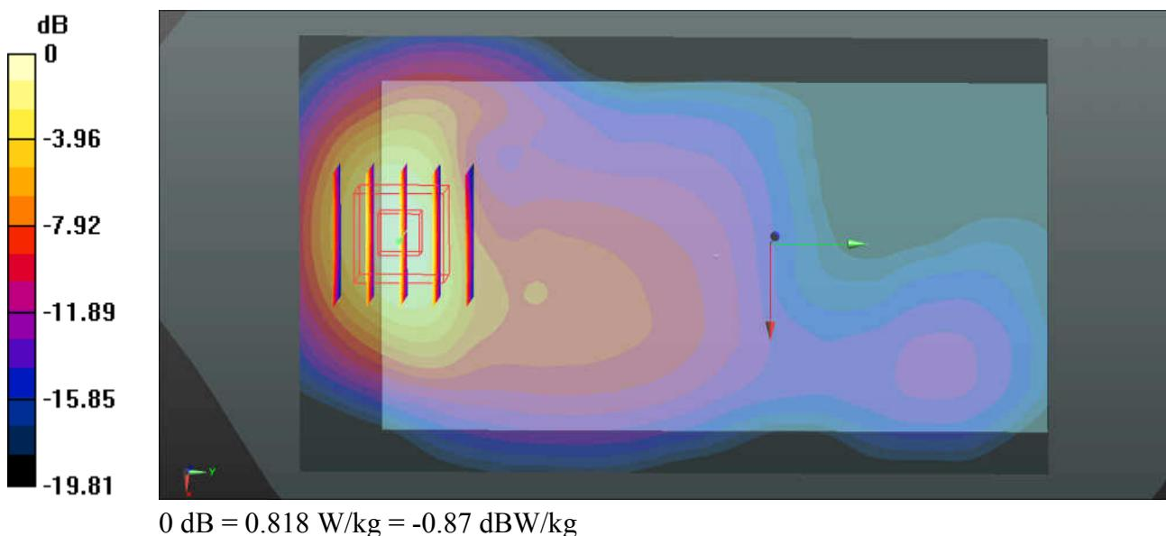
**62\_WLAN2.4GHz\_802.11b 1Mbps\_Front\_10mm\_Ch11\_Ant 1**
