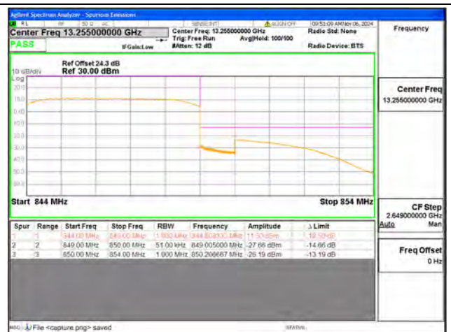
B5 / 5MHz / High CH / QPSK / FULL RB
