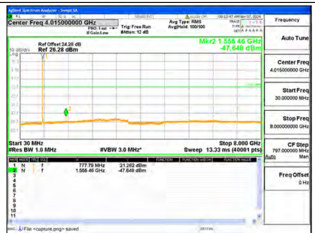
B13 / 10MHz / Mid CH / QPSK
