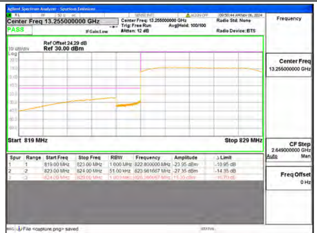
B5 / 5MHz / Low CH / QPSK / FULL RB
