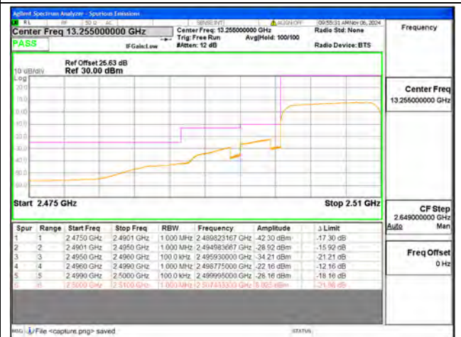
B7 / 10MHz / Low CH / QPSK / FULL RB
