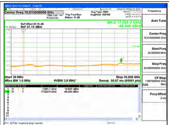
B25 / 1.4MHz / Mid CH / QPSK
