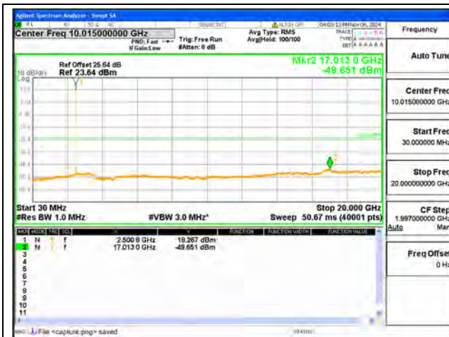
B7-30M-20G / 20MHz / Low CH / QPSK
