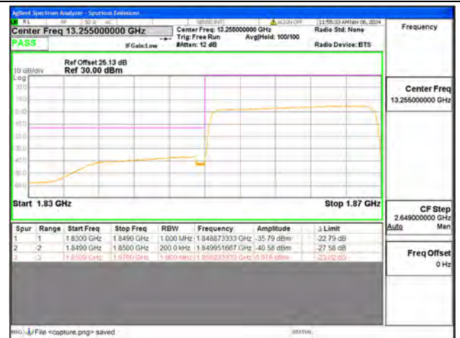
B25 / 20MHz / Low CH / QPSK / FULL RB
