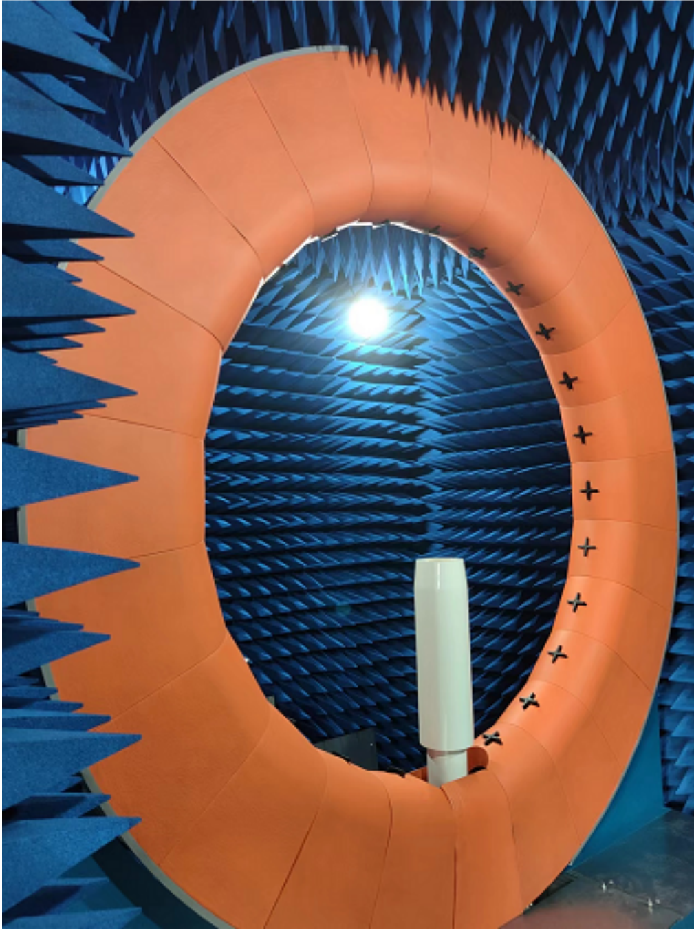
24 探头微波暗室测试设备
