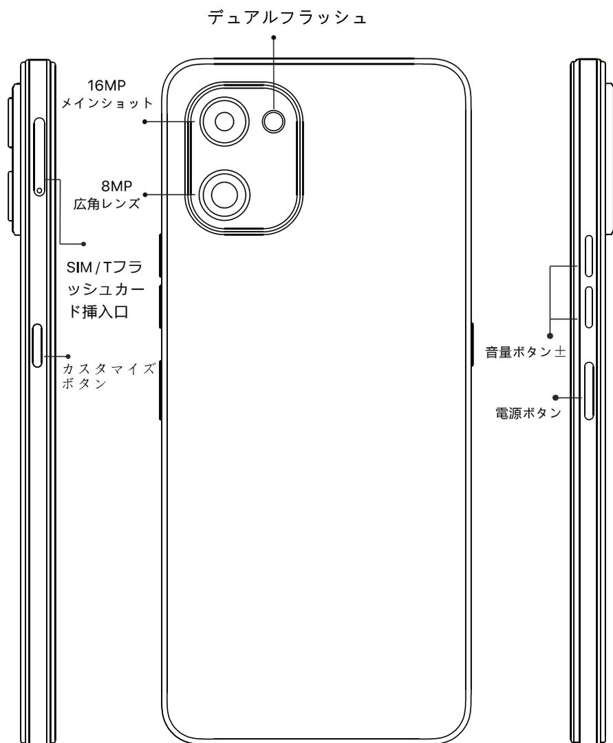
音量キー:短く押すと音量を調節または着信をミュートします。
