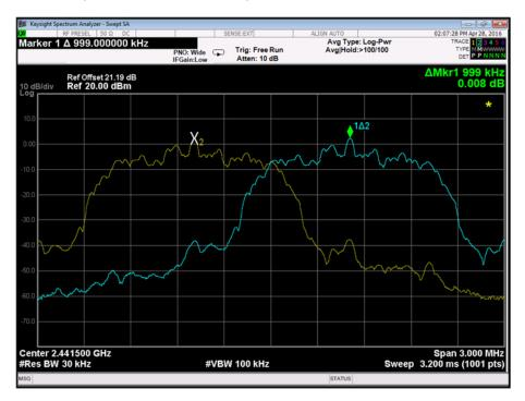
Bluetooth, pi/4 DQPSK, Channel Separation Plot
