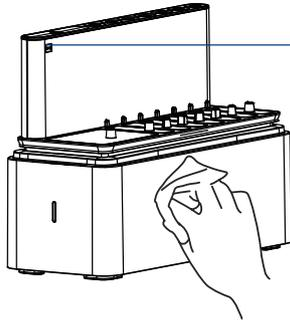
Le capteur de niveau de liquide se trouve ici, veuillez le maintenir propre pour garantir une utilisation normale.
