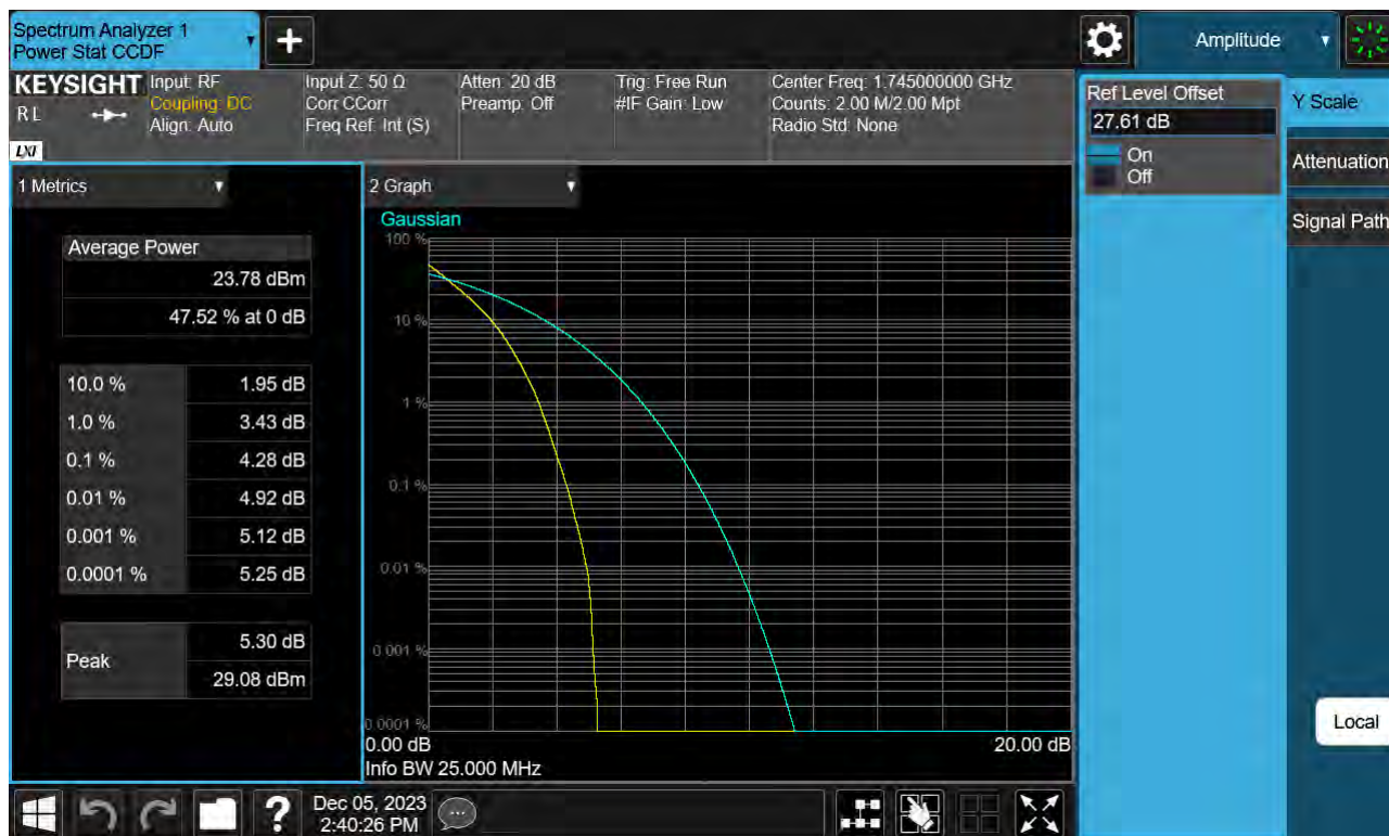
Sub6 n66. PAR Plot (25 M BW_Ch.349000_ BPSK_ Full RB)
