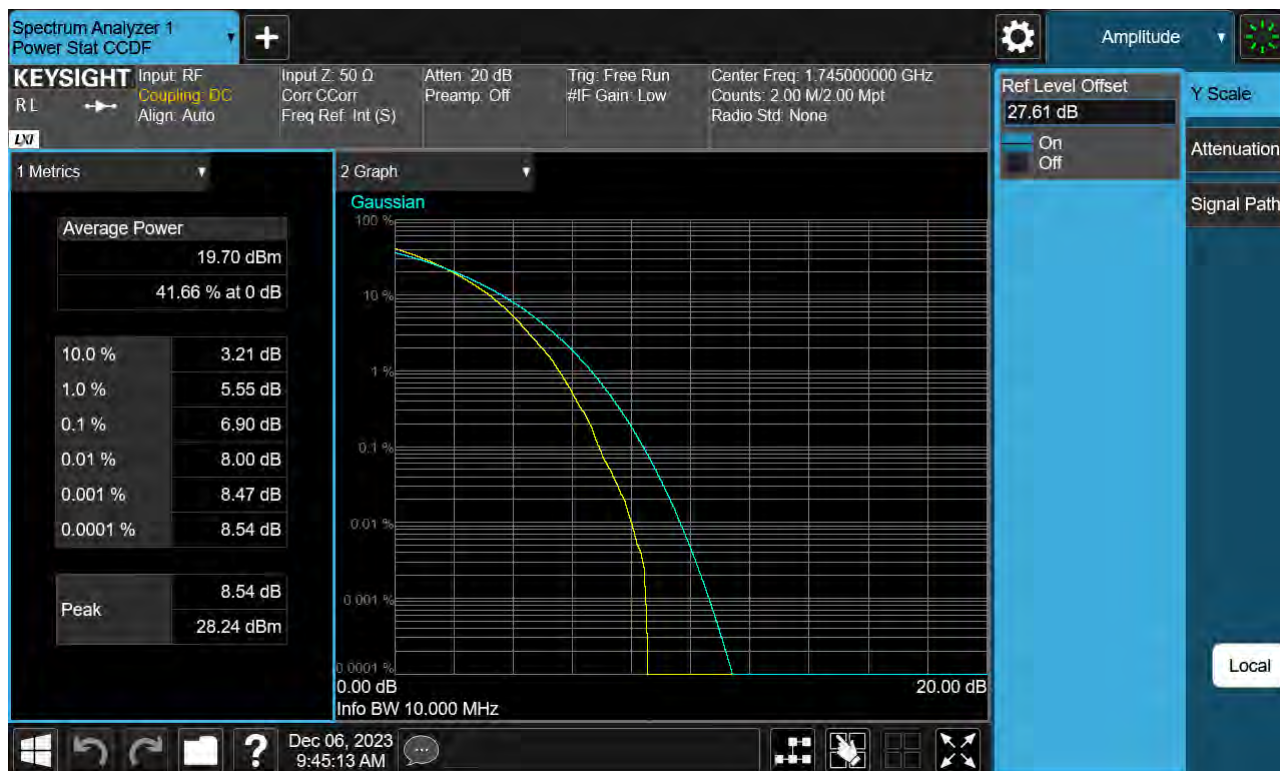
Sub6 n66. PAR Plot (10 M BW_Ch.349000_256QAM_Full RB)
