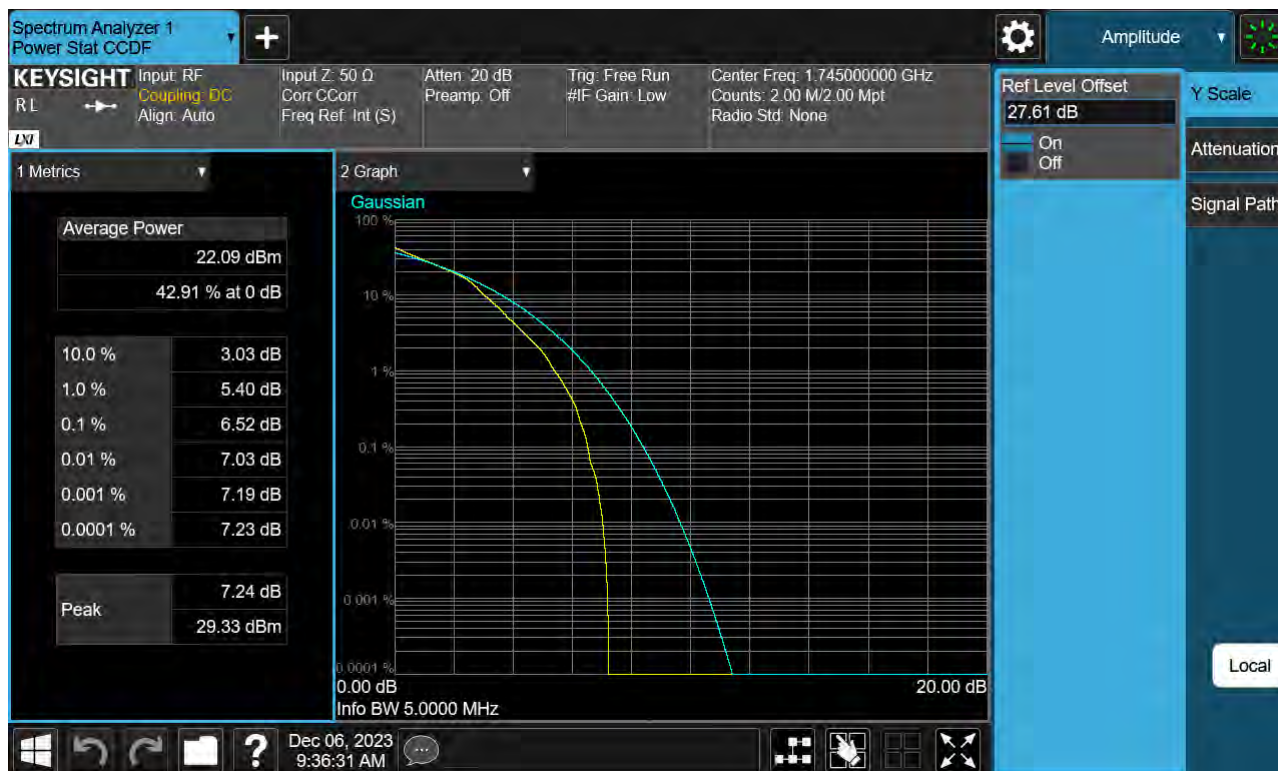
Sub6 n66. PAR Plot (5 M BW_Ch.349000_16QAM_Full RB)
