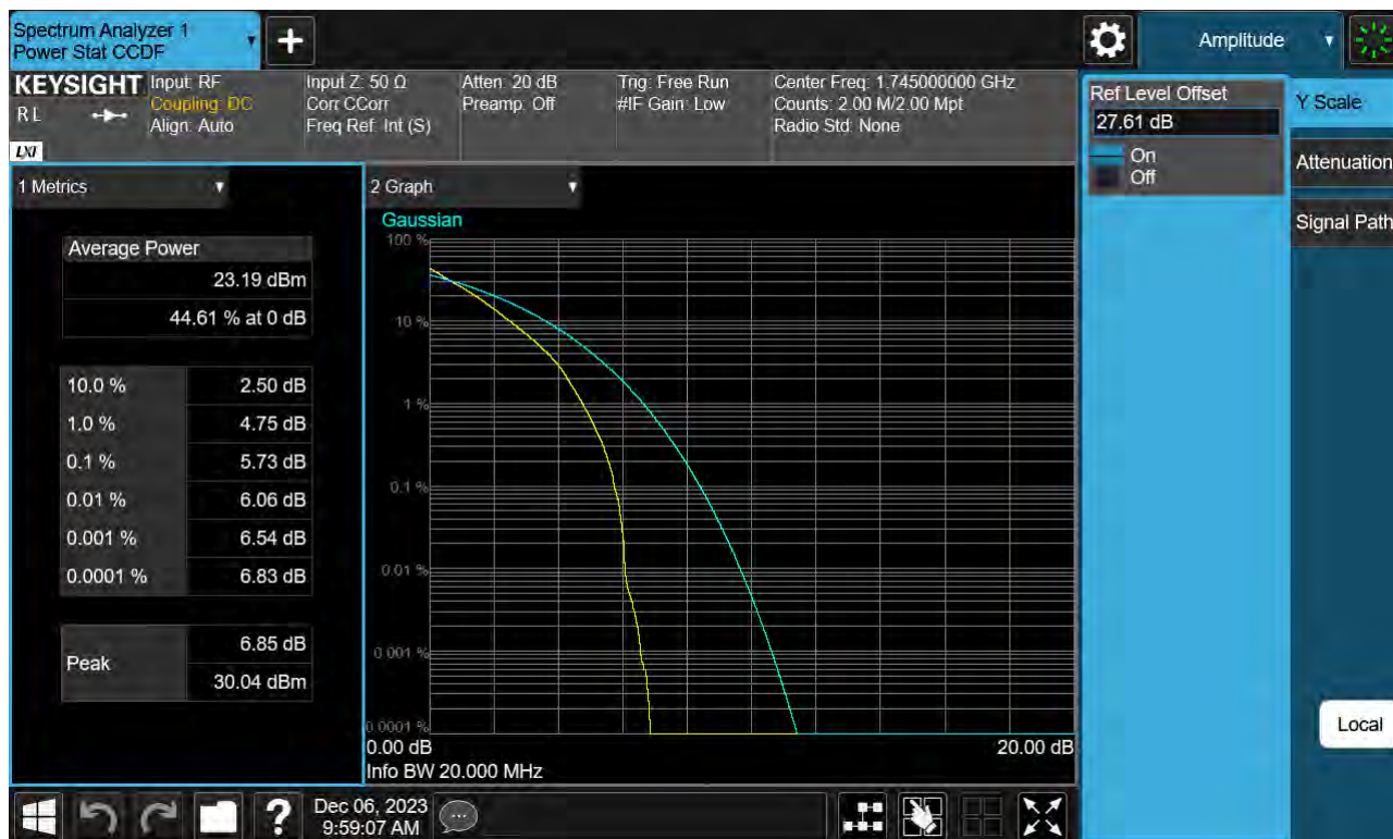
Sub6 n66. PAR Plot (20 M BW_Ch.349000_QPSK_Full RB)
