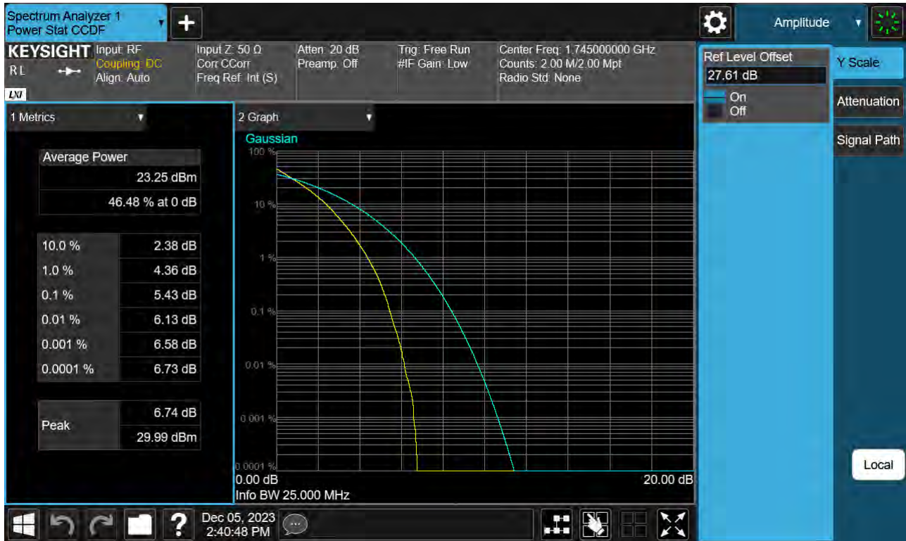
Sub6 n66. PAR Plot (25 M BW_Ch.349000_QPSK_Full RB)
