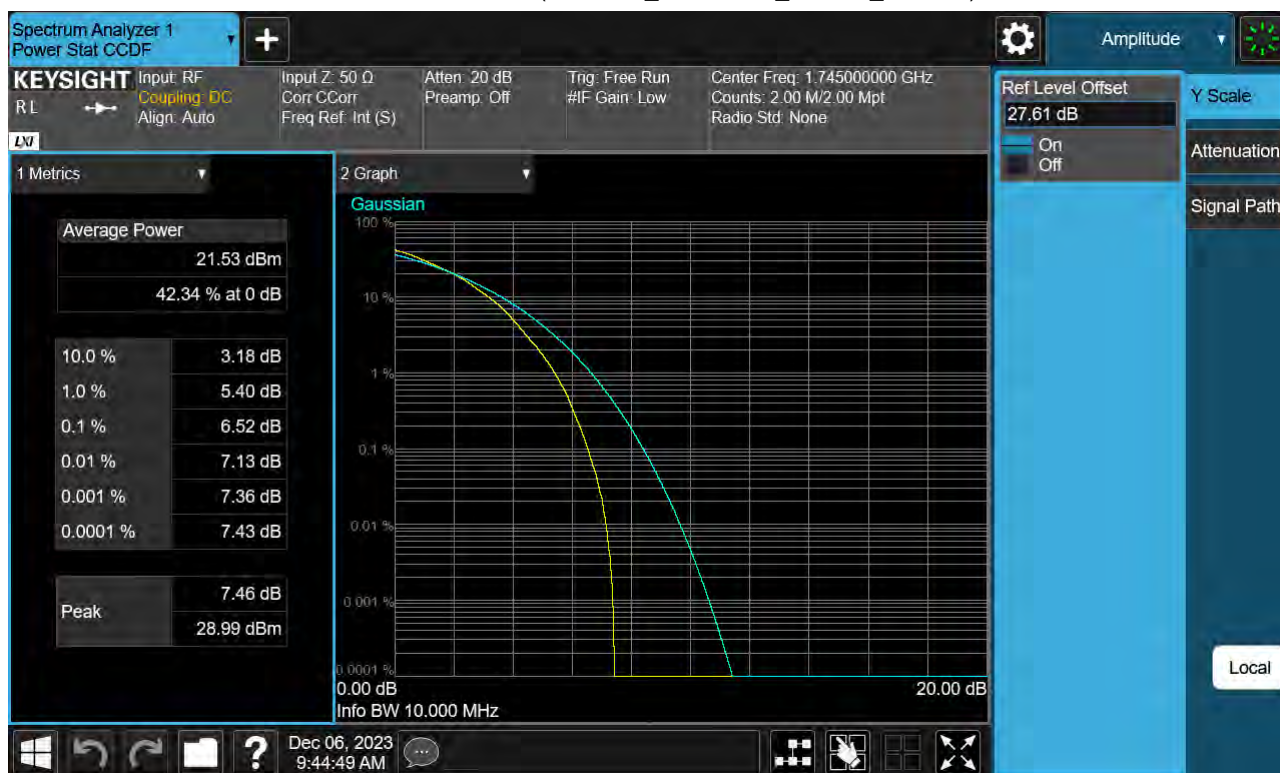
Sub6 n66. PAR Plot (10 M BW_Ch.349000_64QAM_Full RB)
