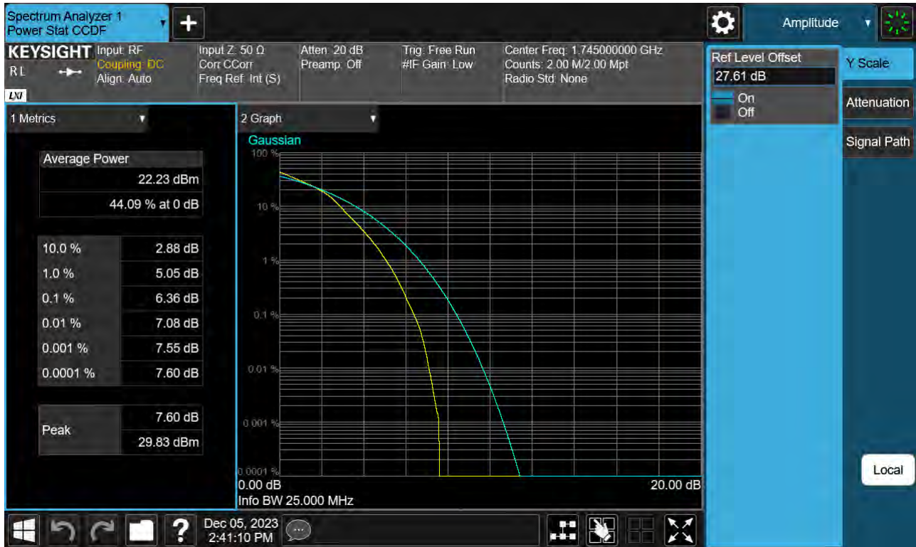
Sub6 n66. PAR Plot (25 M BW_Ch.349000_16QAM_Full RB)
