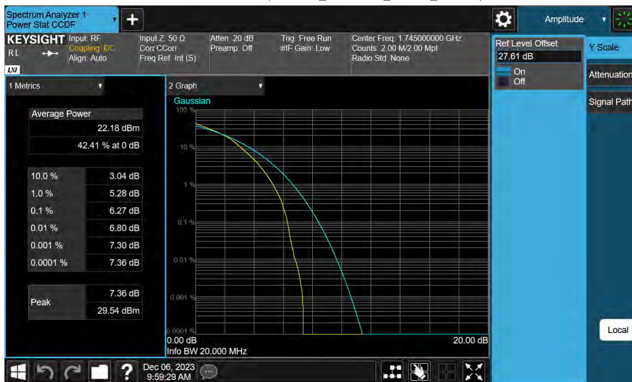
Sub6 n66. PAR Plot (20 M BW_Ch.349000_16QAM_Full RB)
