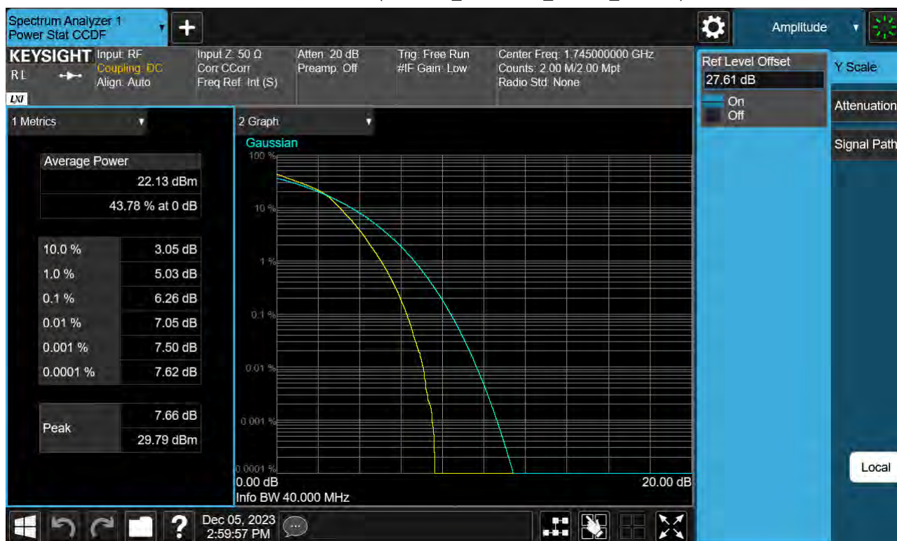
Sub6 n66. PAR Plot (40 M BW_Ch.349000_16QAM_Full RB)
