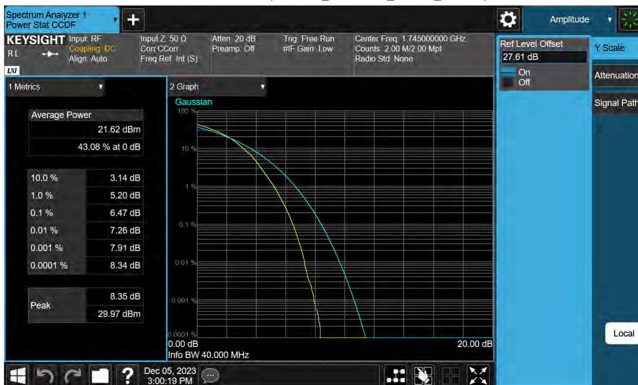
Sub6 n66. PAR Plot (40 M BW_Ch.349000_64QAM_Full RB)
