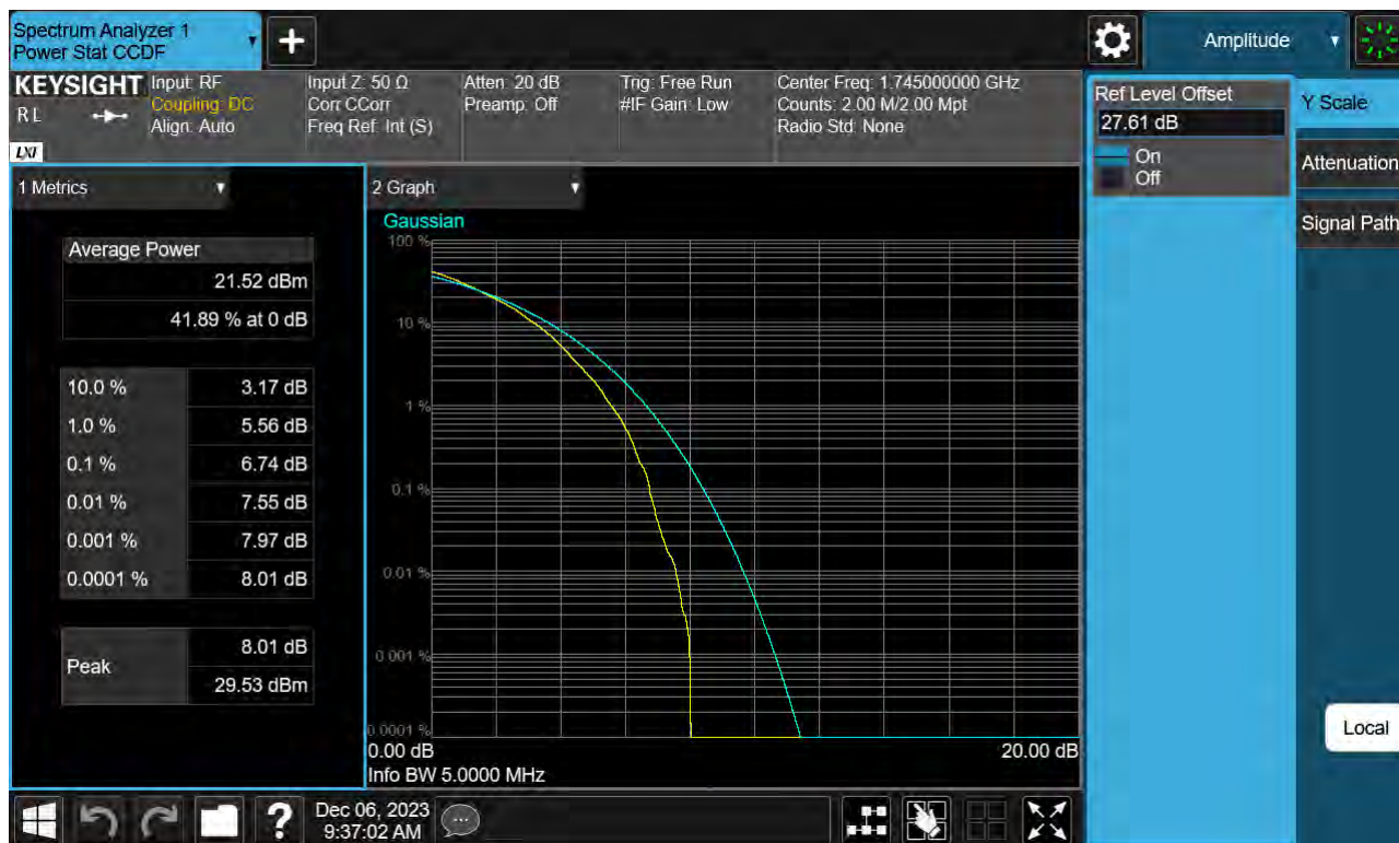
Sub6 n66. PAR Plot (5 M BW_Ch.349000_64QAM_Full RB)
