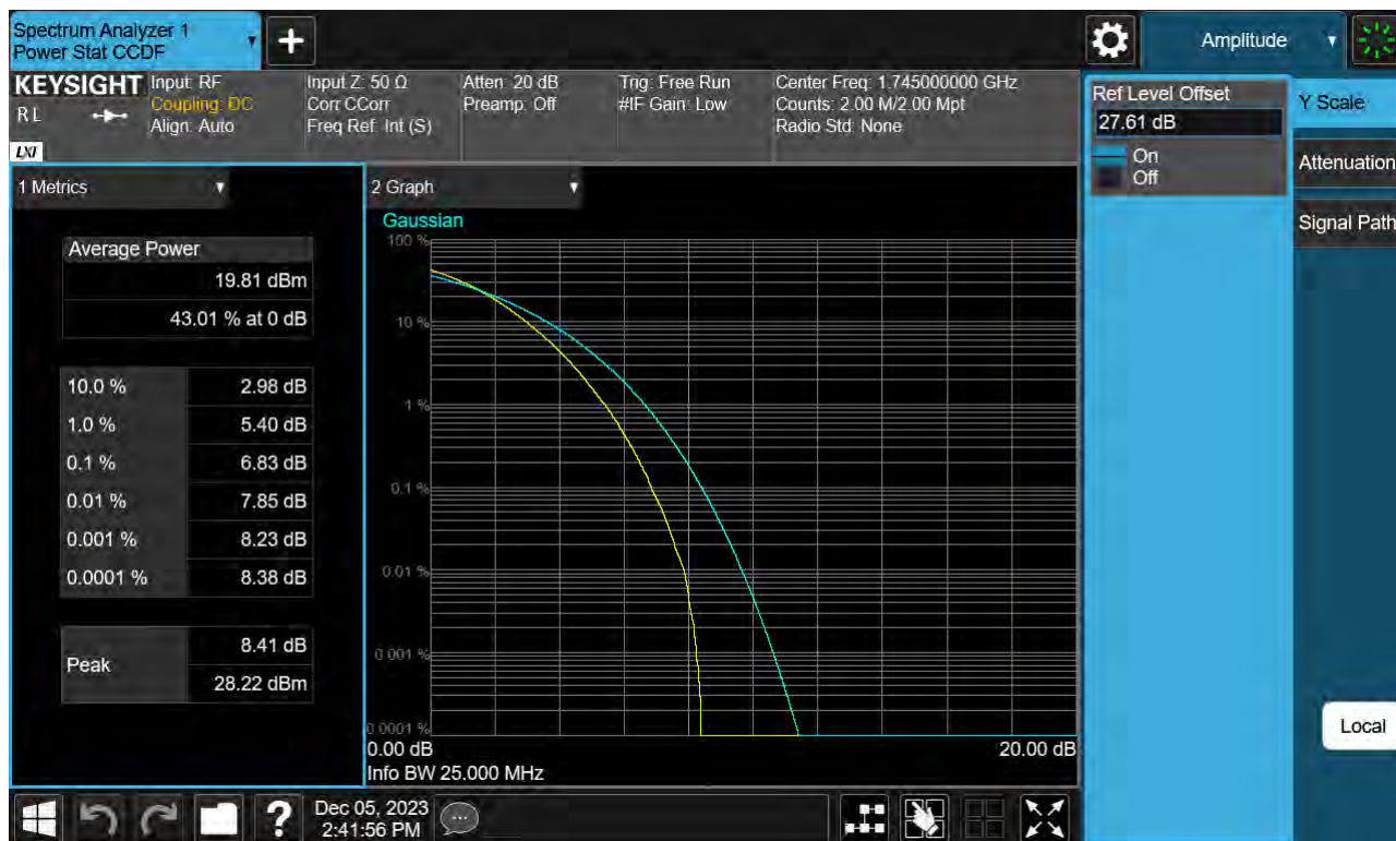
Sub6 n66. PAR Plot (25 M BW_Ch.349000_256QAM_Full RB)
