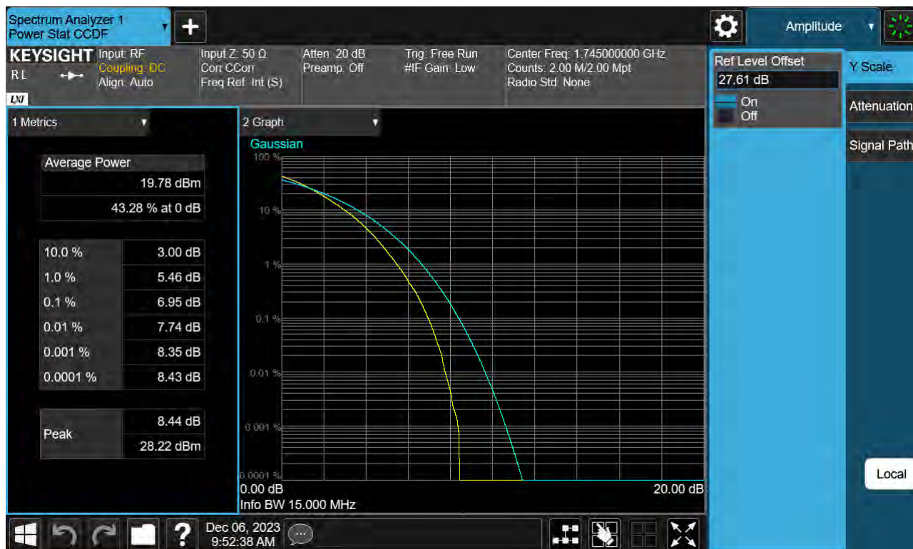
Sub6 n66. PAR Plot (15 M BW_Ch.349000_256QAM_Full RB)
