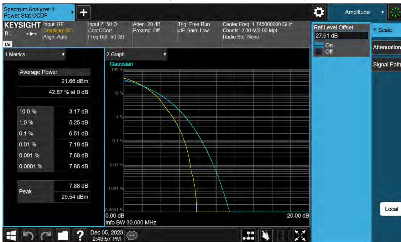
Sub6 n66. PAR Plot (30 M BW_Ch.349000_64QAM_Full RB)
