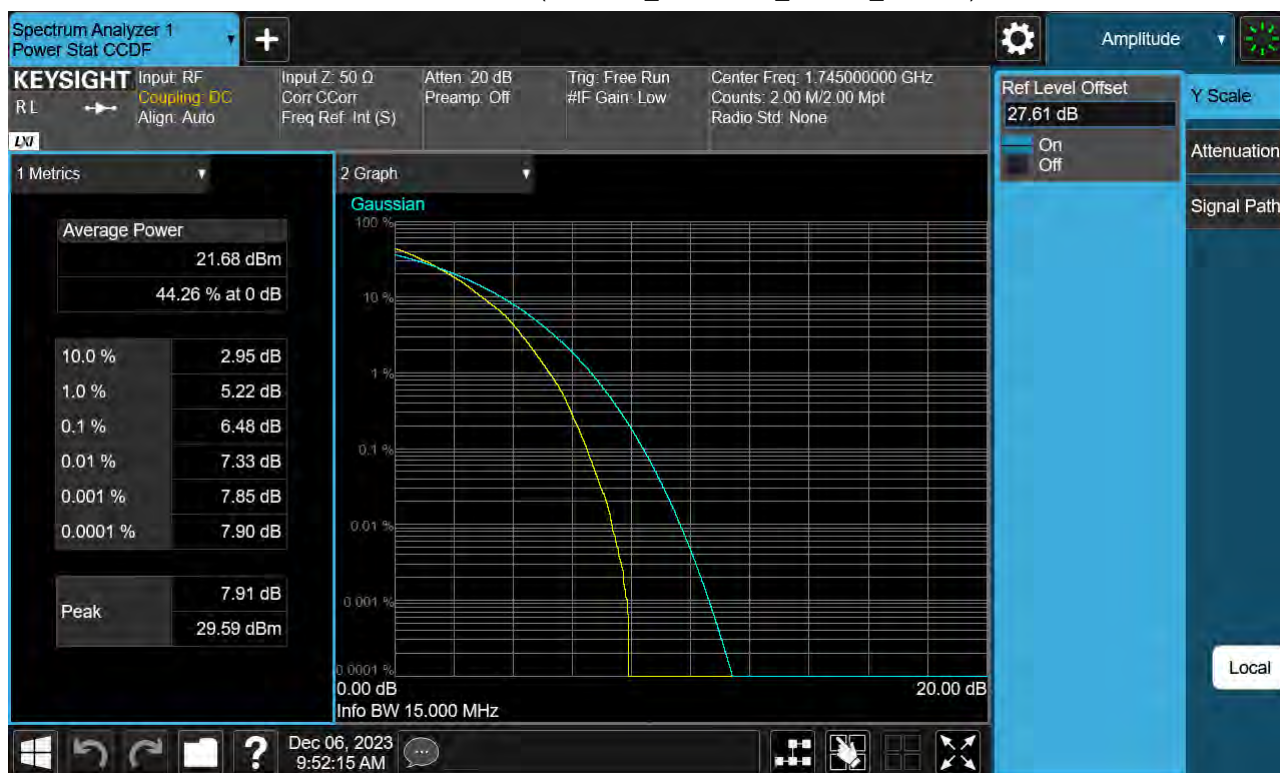
Sub6 n66. PAR Plot (15 M BW_Ch.349000_64QAM_Full RB)
