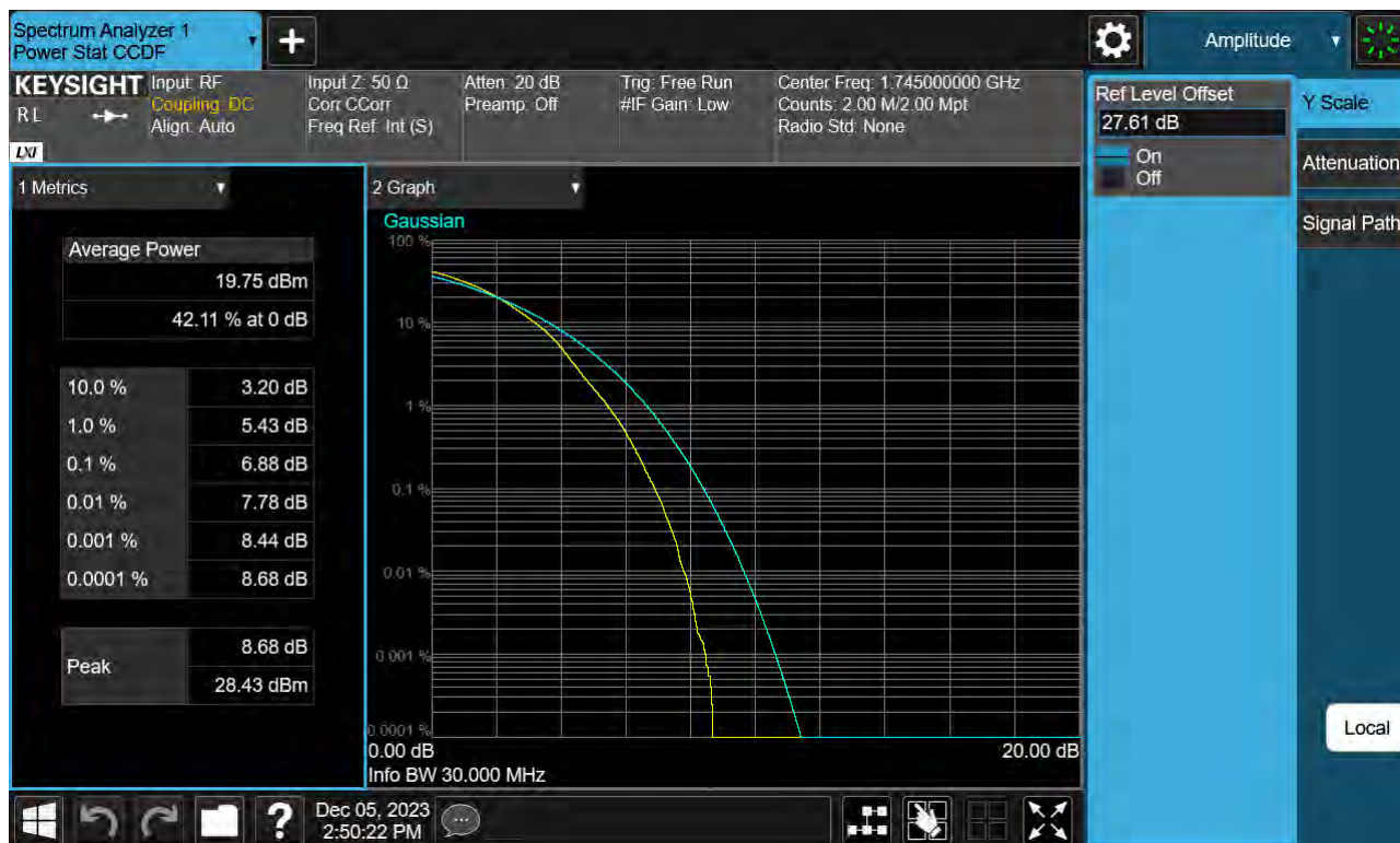
Sub6 n66. PAR Plot (30 M BW_Ch.349000_256QAM_Full RB)
