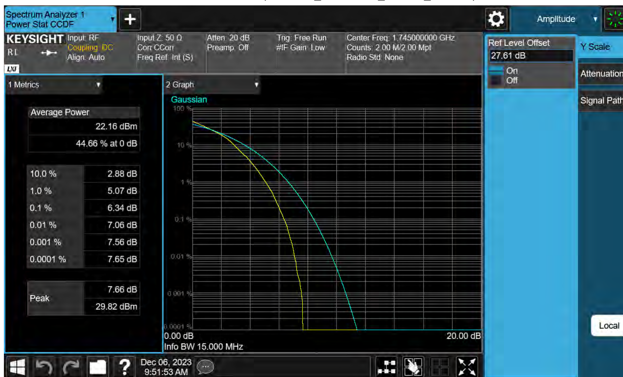
Sub6 n66. PAR Plot (15 M BW_Ch.349000_16QAM_Full RB)
