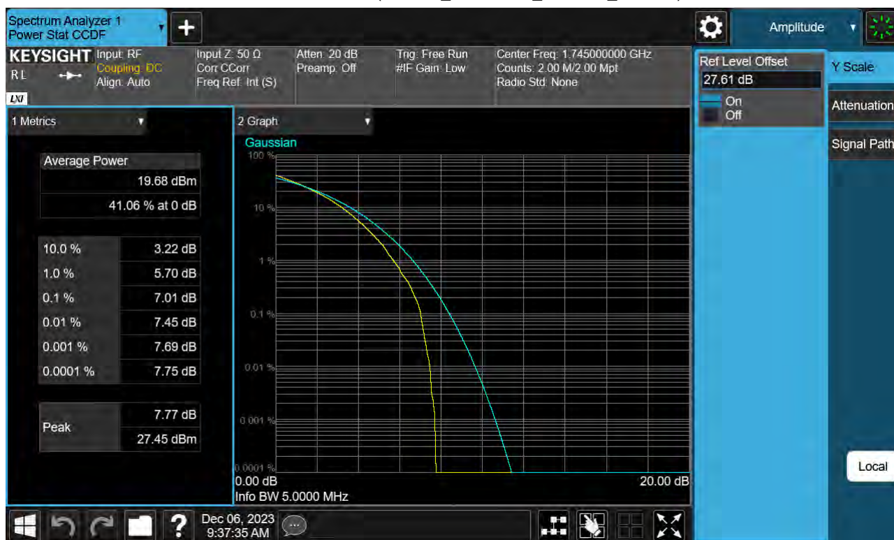
Sub6 n66. PAR Plot (5 M BW_Ch.349000_256QAM_Full RB)
