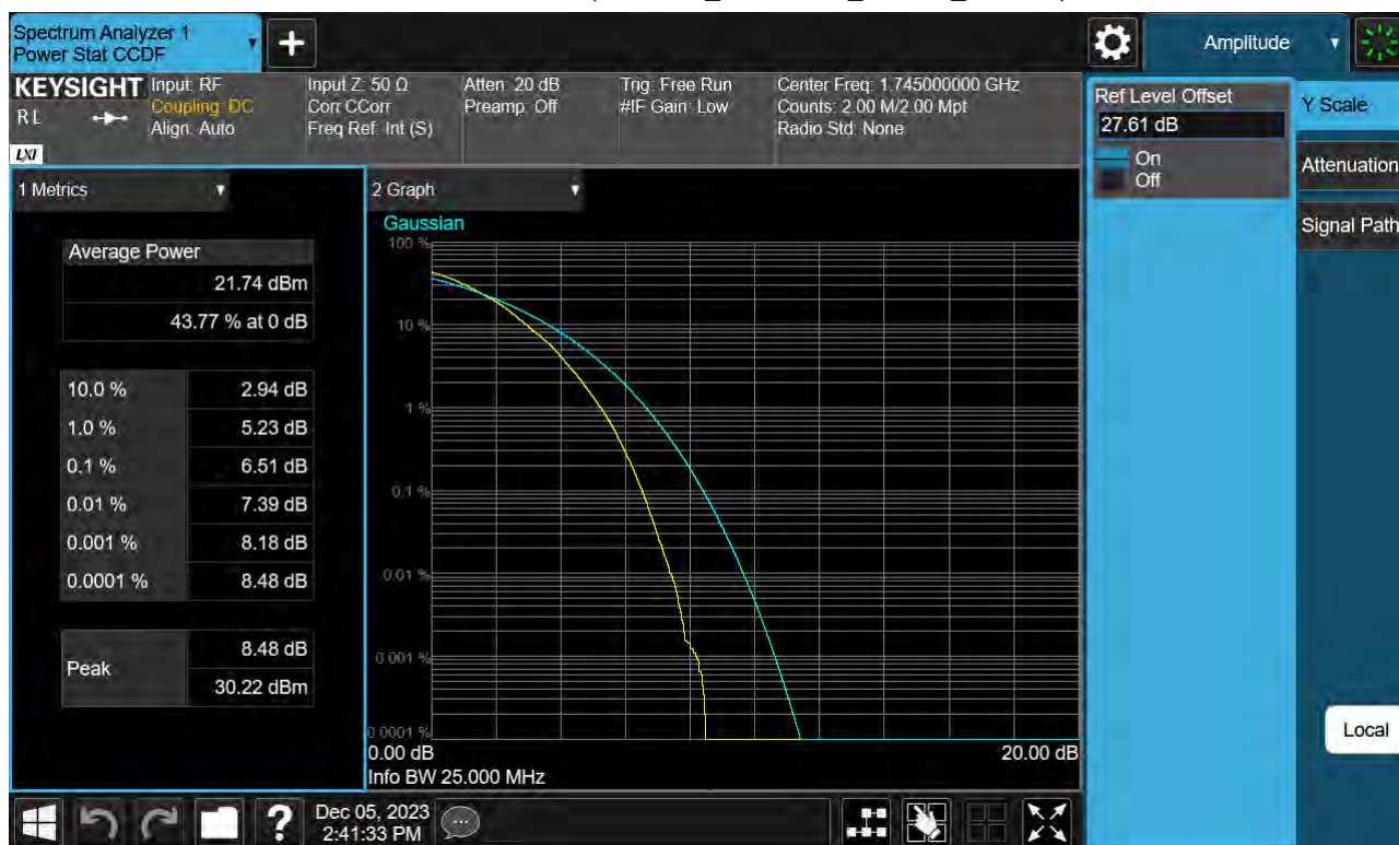
Sub6 n66. PAR Plot (25 M BW_Ch.349000_64QAM_Full RB)
