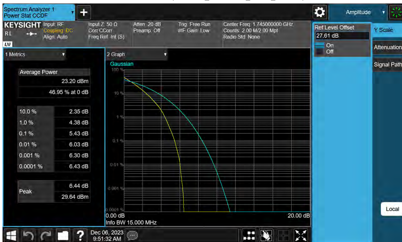
Sub6 n66. PAR Plot (15 M BW_Ch.349000_QPSK_Full RB)
