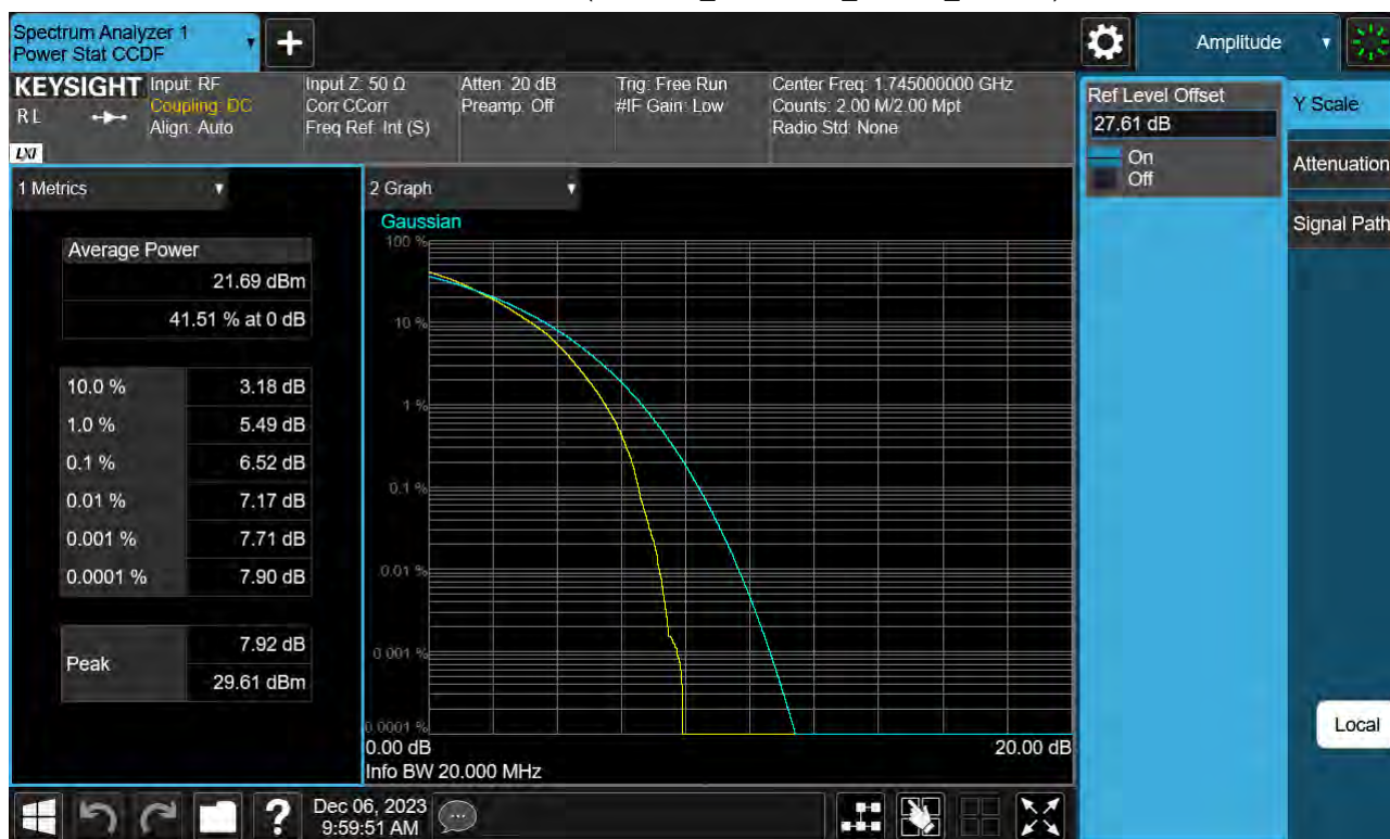
Sub6 n66. PAR Plot (20 M BW_Ch.349000_64QAM_Full RB)
