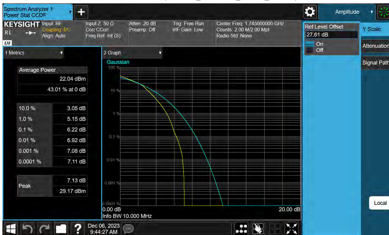
Sub6 n66. PAR Plot (10 M BW_Ch.349000_16QAM_Full RB)
