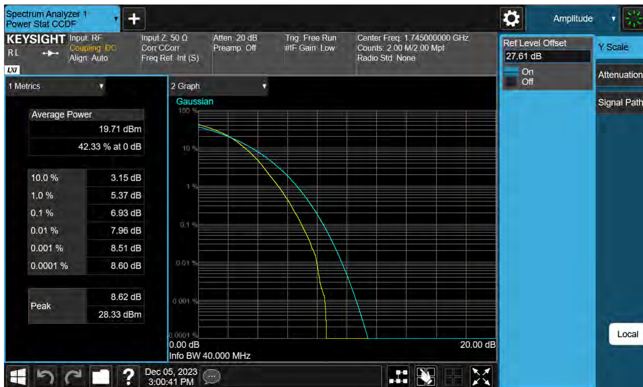
Sub6 n66. PAR Plot (40 M BW_Ch.349000_256QAM_Full RB)
