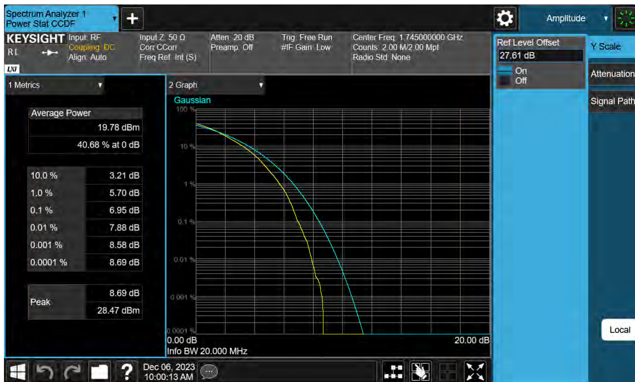
Sub6 n66. PAR Plot (20 M BW_Ch.349000_256QAM_Full RB)
