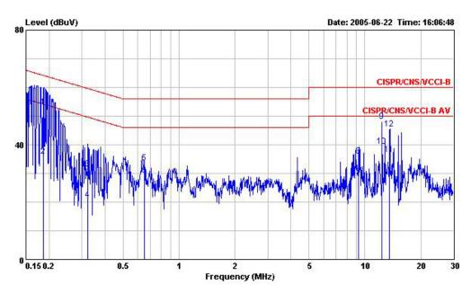
Site : CO04-HY Condition : CISPR/CNS/VCCI-B LISN 2003 /008 LINE EUT : ST585v6 Power : 110V 60Hz Model : LAN 10/100Mbps TEST PORT : AC PORT ADSL mode : ADSL 2+ ANNEX A 100Mbps Loop Length : 3000 ft Over Limit Read LISN Cable
