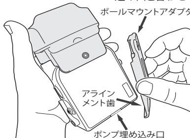
13. CADD®-Solis ポンプキー、標準のスクリュードライバまたは硬貨を使ってスクリューを締めてポールマウントアダプタを取り付け、通信モジュールをポンプにしっかりと固定します。しっかりと収まるように締め付け、さらに約 1/8 回転 (45°) 回します。締め付けすぎないでください。
