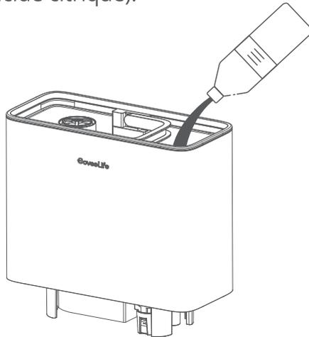
2. Mettez le couvercle du réservoir et agitez le vinaigre dans le réservoir.
