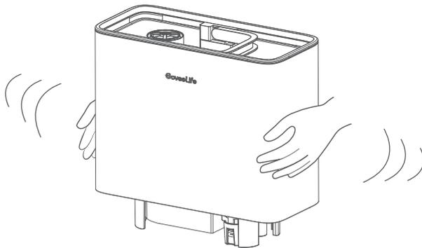
3. Placez le réservoir sur la base et laissez-le reposer pendant 15 à 20 minutes jusqu'à ce que le vinaigre détache les dépôts de tartre.
