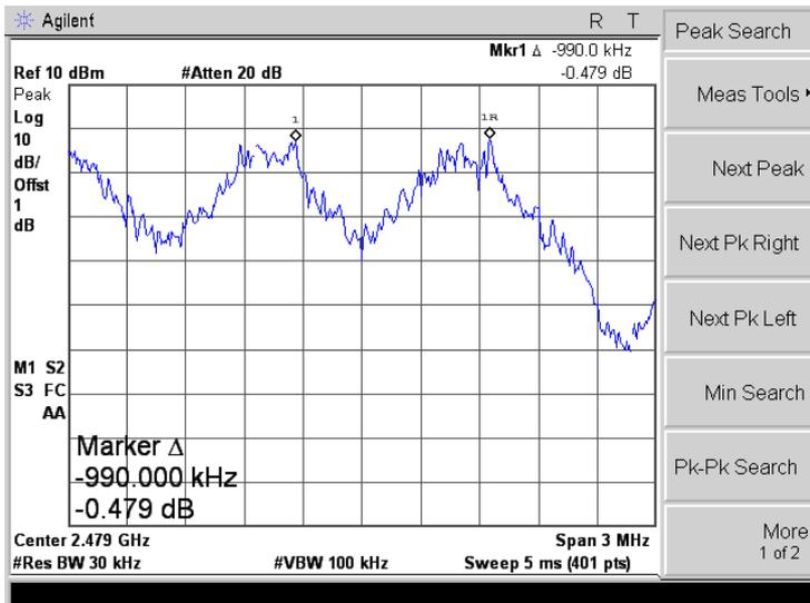
Channel Separation- Pi/4 DQPSK
