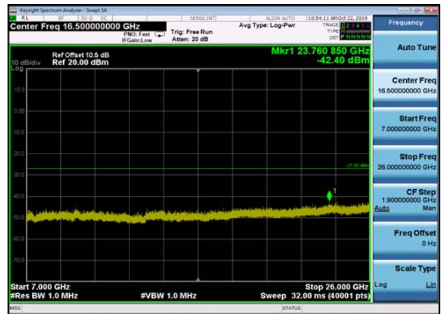
U-NII-2a ,Plot 4,7000MHz~26000MHz-802 .11ac(80MHz),5290MHz
