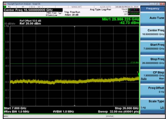
U-NII-2a ,Plot 4,7000MHz~26000MHz-802 .11a(20MHz),5320MHz
