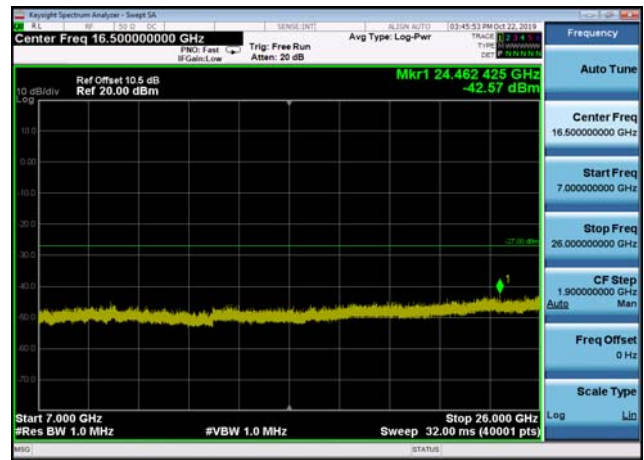
U-NII-2c ,Plot 4,7000MHz~26000MHz-802 .11n(40MHz),5670MHz
