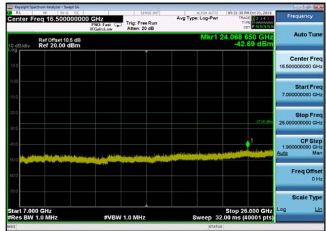
U-NII-2a ,Plot 4,7000MHz~26000MHz-802 .11ac(20MHz),5300MHz
