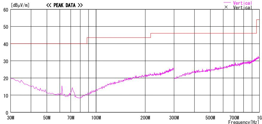
CHART:WITH FACTOR ANT TYPE : -30MHz LOOP, 30-300MHz BICONICAL, 300MHz-1000MHz LOGPERIODIC, 1000MHz- HORN
