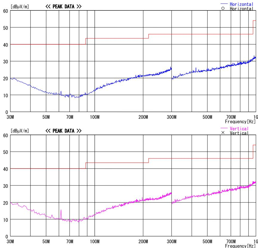
CHART:WITH FACTOR ANT TYPE : -30MHz LOOP, 30-300MHz BICONICAL, 300MHz-1000MHz LOGPERIODIC, 1000MHz- HORN
