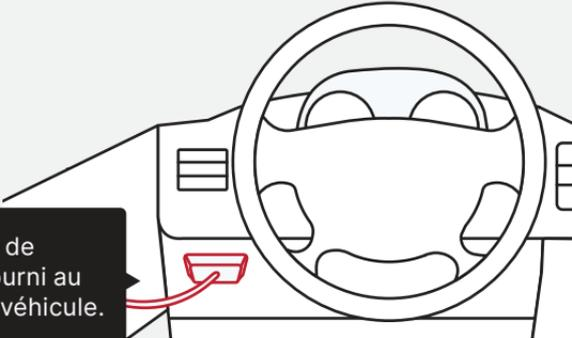
Connectez l'extrémité de diagnostic du câble fourni au port de diagnostic du véhicule.
