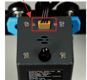
Verkabelung des Lasermoduls
