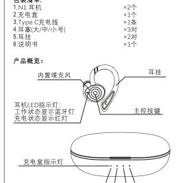
开/关机: 将耳机置于充电盒内并打开盖子,耳机就可以开机。 将耳机放回充电盒内并关上盖子,耳机就可以关机。 长按主控按键3秒可以手动开机或者是关机。 注意:使用前请检查充电盒电量,如果充电盒没有电了, 请先充电后再使用!
