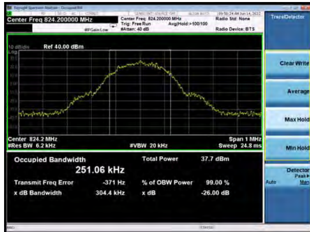
GSM 1900 GSM CH-Middle
