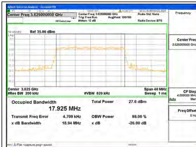
B48 / 20MHz / QPSK/ Mid CH
