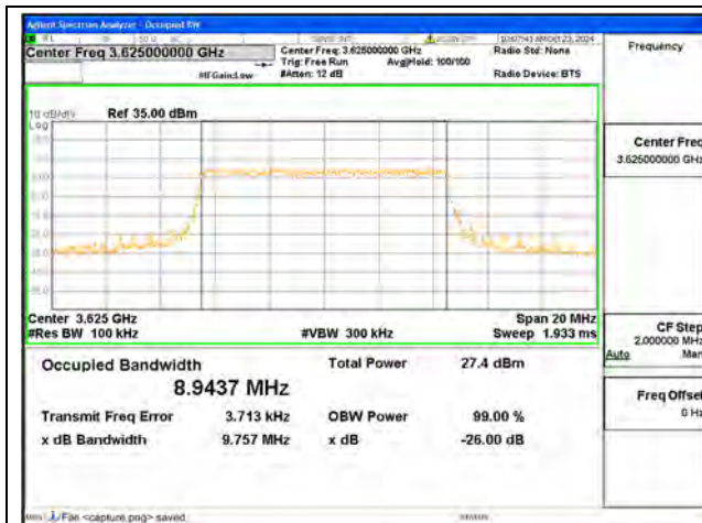
B48 / 10MHz / QPSK/ Mid CH
