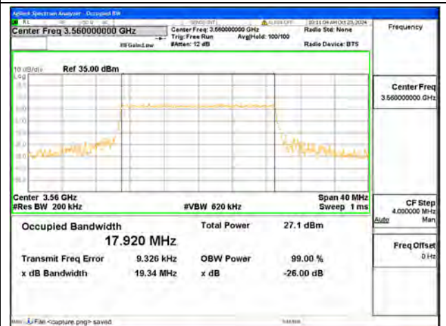
B48 / 20MHz / 64QAM/ Low CH
