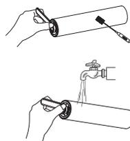
Utilisez l'outil de nettoyage pour retirer les cheveux et les débris enroulés autour du rouleau et rincez celui-ci à l'eau. Remplacez le rouleau brosse dans le porte-accessoires et laissez-le sécher complètement avant de le réinstaller.
