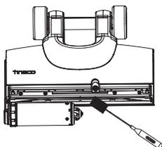
Retirez les cheveux et les débris du compartiment du rouleau brosse et de l'ouverture à l'aide de l'outil de nettoyage.
