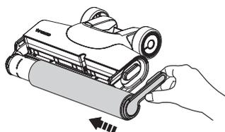
Remettez le rouleau brosse en place en insérant son extrémité dans le côté gauche du support, puis fixez la languette du rouleau à la boucle magnétique à droite pour la verrouiller en place.
