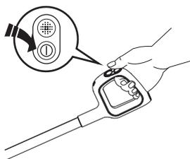
Appuyez sur le bouton ① pour que l'appareil démarre en mode AUTO par défaut. Appuyez à nouveau sur ce bouton pour éteindre l'appareil. Alterniez entre les modes AUTO, MAX et SUCTION en appuyant sur le bouton ②.
