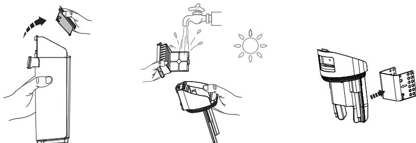
Saisissez les zones en creux de chaque côté du filtre sec et tirez vers le haut. Rincez sous l'eau courante et laissez sécher complètement avant de replacer le filtre sec dans le couvercle du RES.
