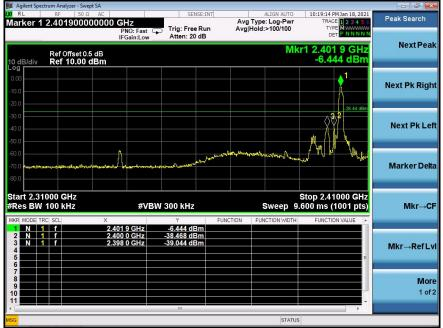
Pi/4 DQPSK Transmitting Band edge-left side
