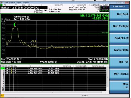
Pi/4 DQPSK Transmitting Band edge-right side
