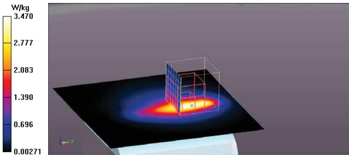
**Test Laboratory: Eurofins Product Service GmbH****Bluetooth DH5 2402 MHz - BACK 0mm****DUT: Asthma Monitor AM3; Type: AM3 Option G+; Serial: -**
