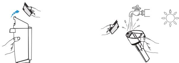
Saisissez les zones en creux de chaque côté du filtre HEPA et tirez vers le haut. Rincez sous l'eau courante et laissez sécher complètement avant de replacer le filtre HEPA dans le couvercle du RES.
