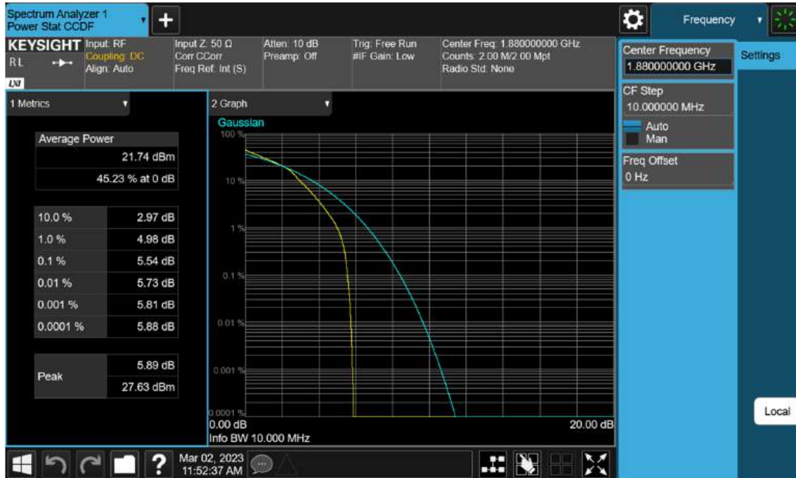
Sub6 n2. PAR Plot (10 M BW Ch.376000 16QAM RB 50_0)
