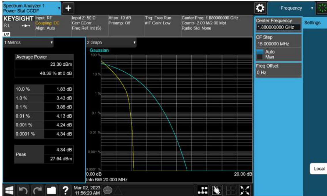
Sub6 n2. PAR Plot (20 M BW Ch.376000 BPSK RB 100_0)
