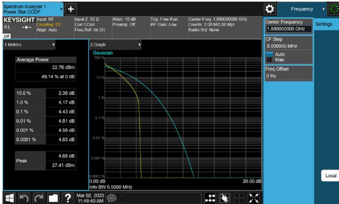
Sub6 n2. PAR Plot (5 M BW Ch.376000 QPSK RB 25_0)
