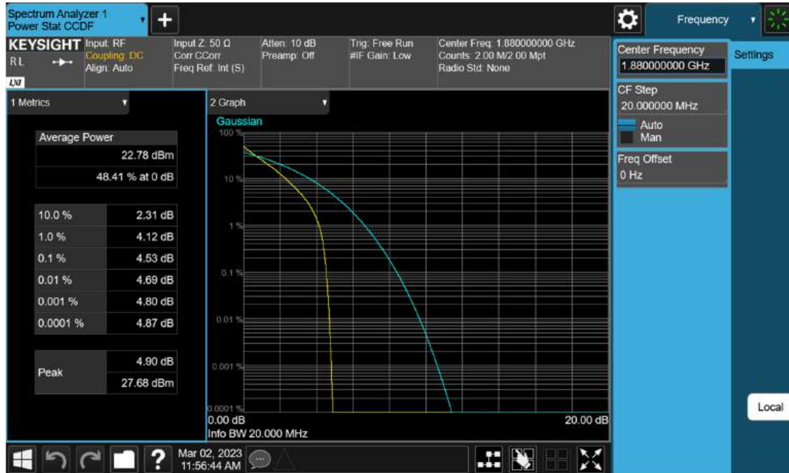
Sub6 n2. PAR Plot (20 M BW Ch.376000 QPSK RB 100_0)
