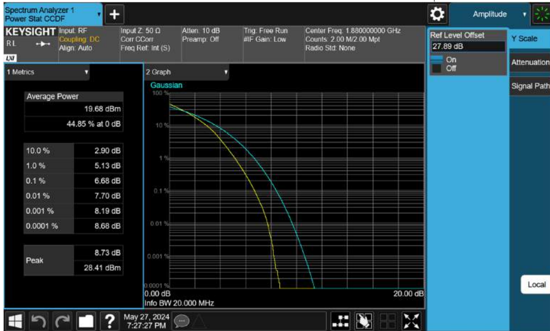
Sub6 n2. PAR Plot (20 M BW Ch.376000 256QAM RB 100_0)
