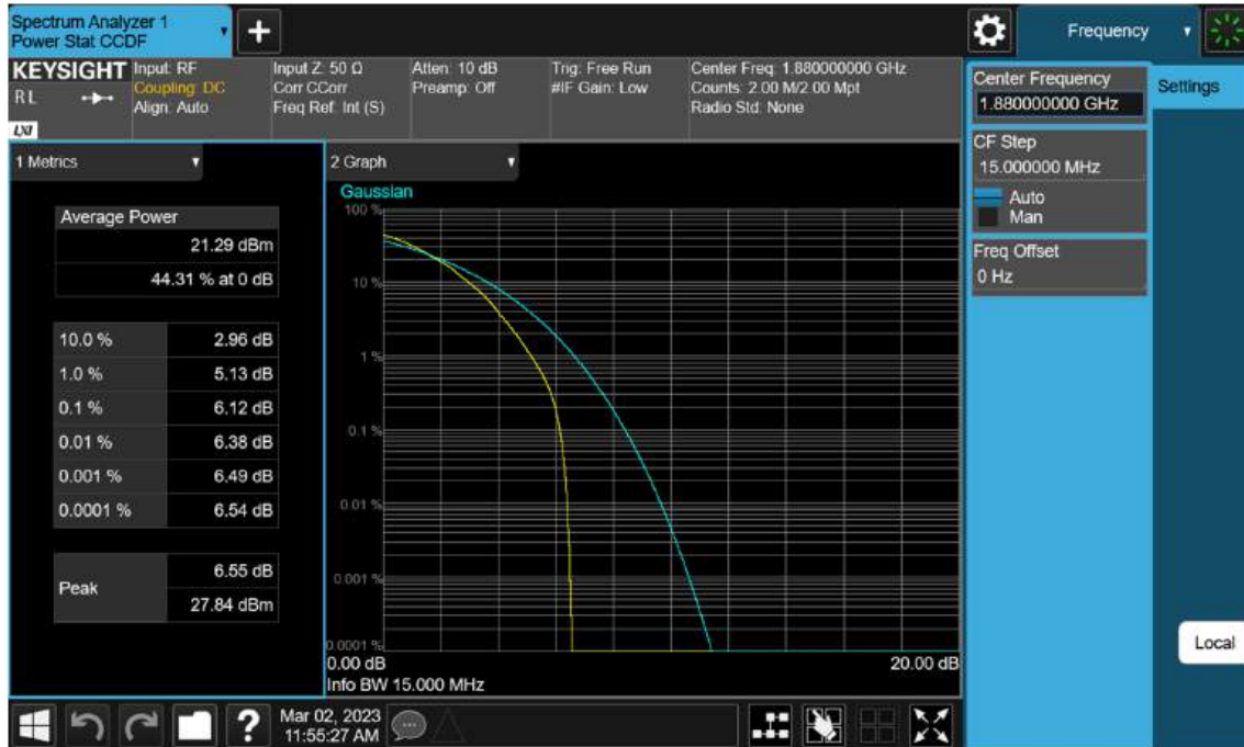
Sub6 n2. PAR Plot (15 M BW Ch.376000 64QAM RB 75_0)
