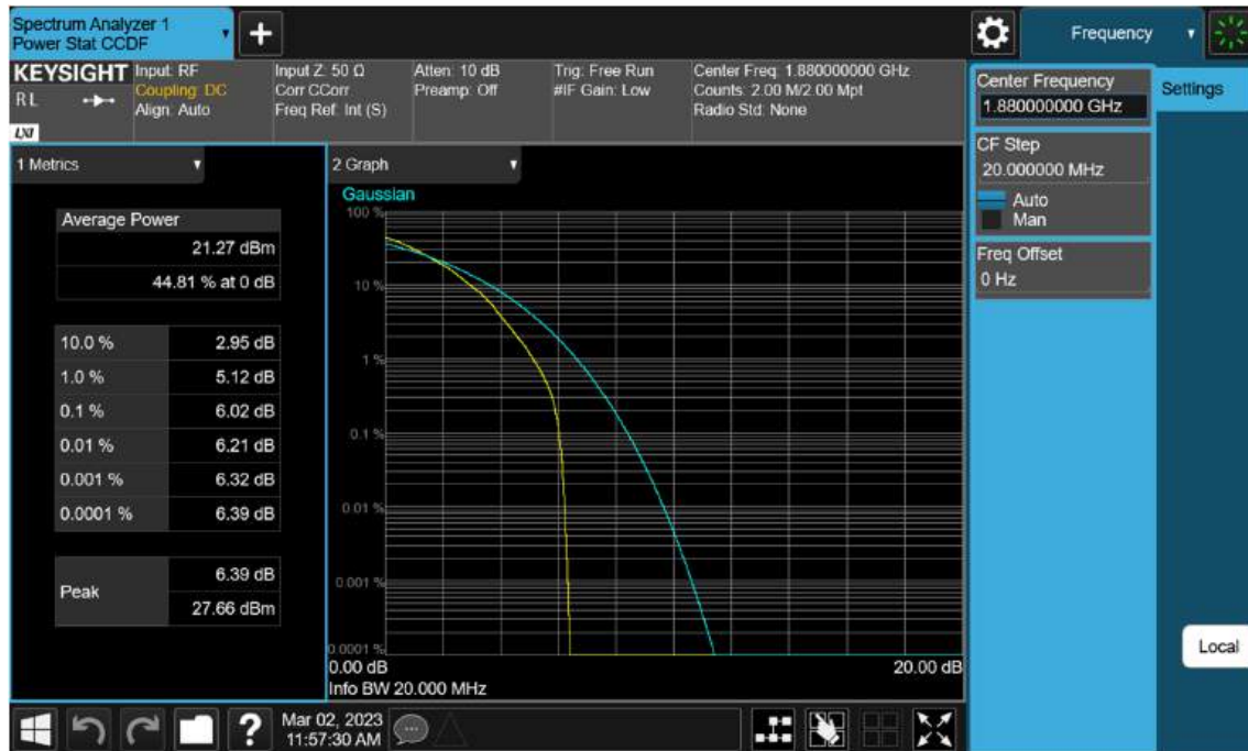
Sub6 n2. PAR Plot (20 M BW Ch.376000 64QAM RB 100_0)
