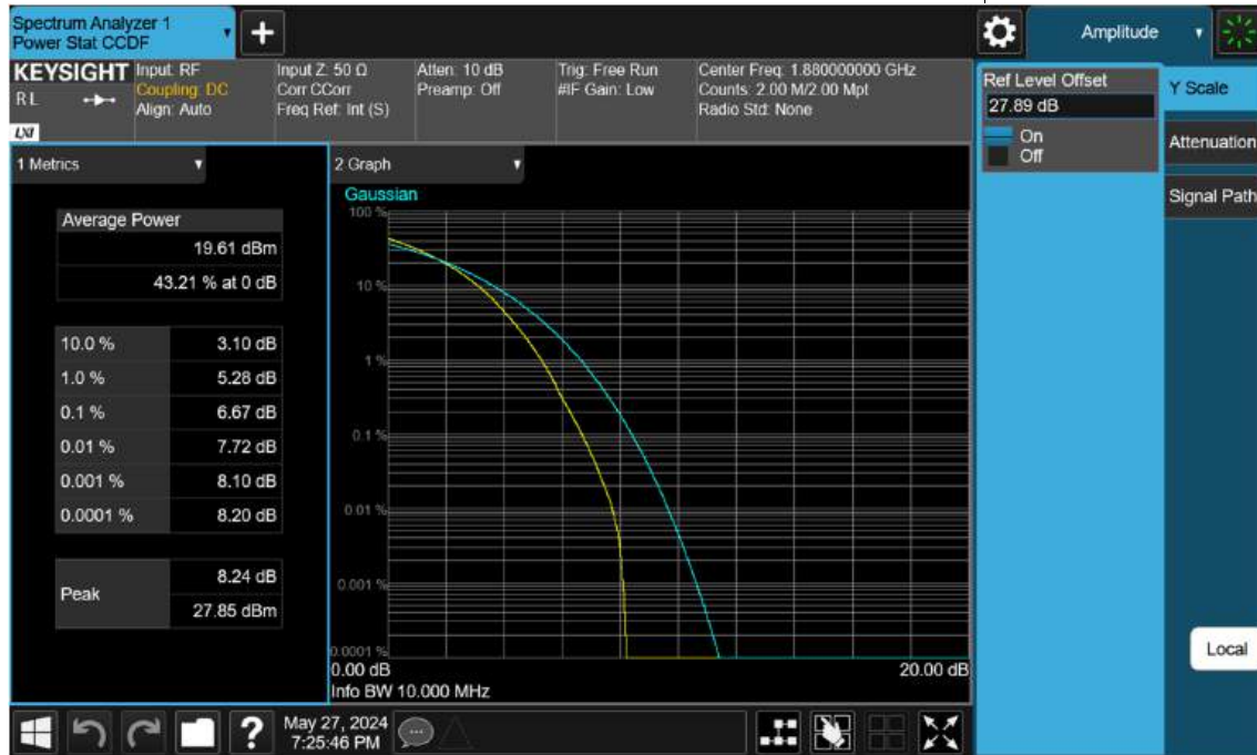
Sub6 n2. PAR Plot (10 M BW Ch.376000 256QAM RB 50_0)
