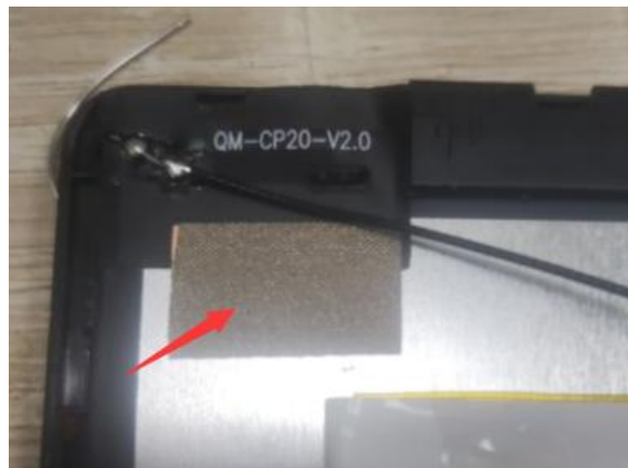
天线漏铜区用导电布与屏接地
