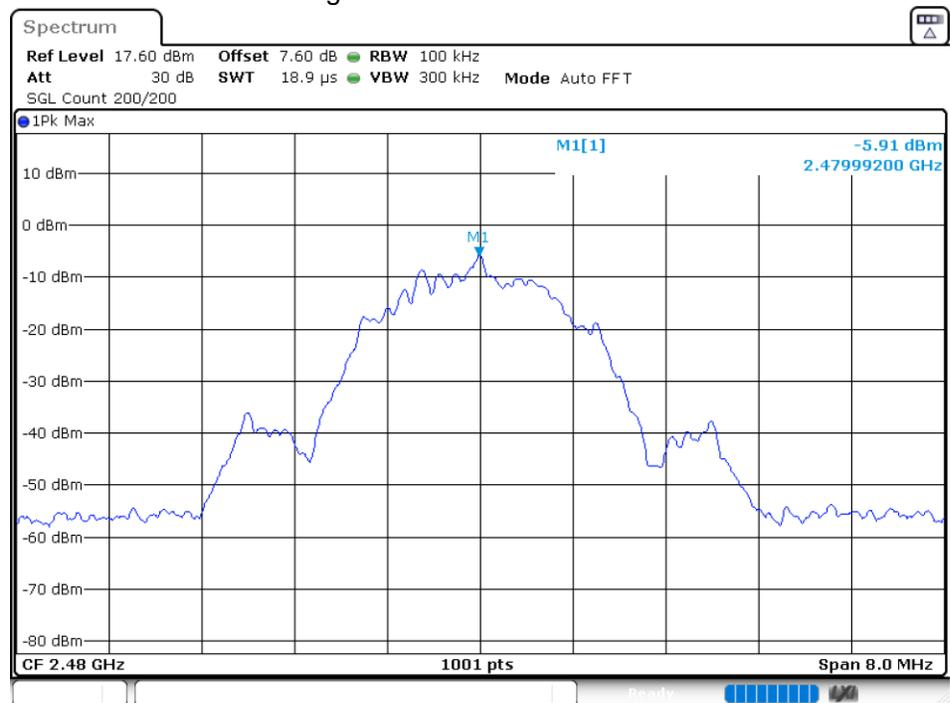
Band Edge NVNT BLE 2480MHz Ant1 Emission
