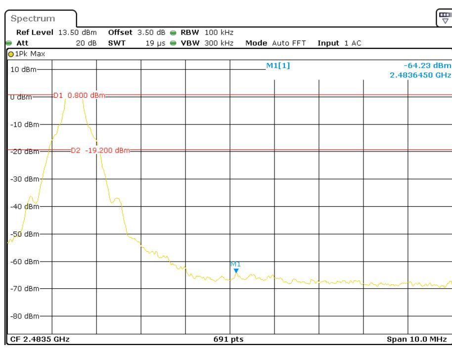
**EDR ( $\pi/4$ -DQPSK): Band Edge-Left Side**
