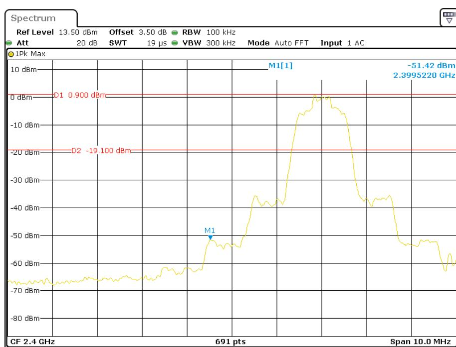
**EDR ( $\pi/4$ -DQPSK): Band Edge-Right Side**
