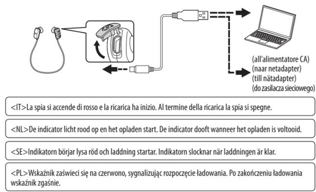
CONNECTING / VERBINDEN / CONNEXION / CONEXIÓN
