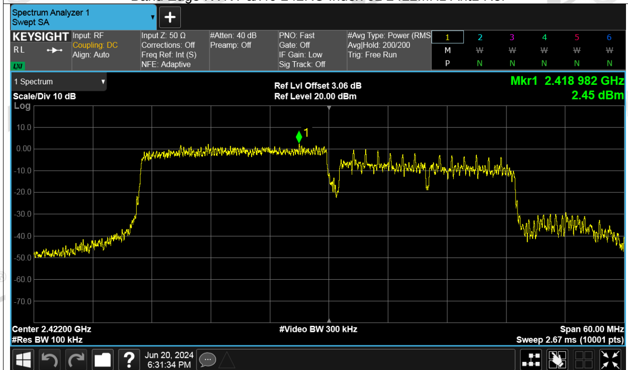
Band Edge NVNT ax40 242RU Index 61 2422MHz Ant1 Emission
