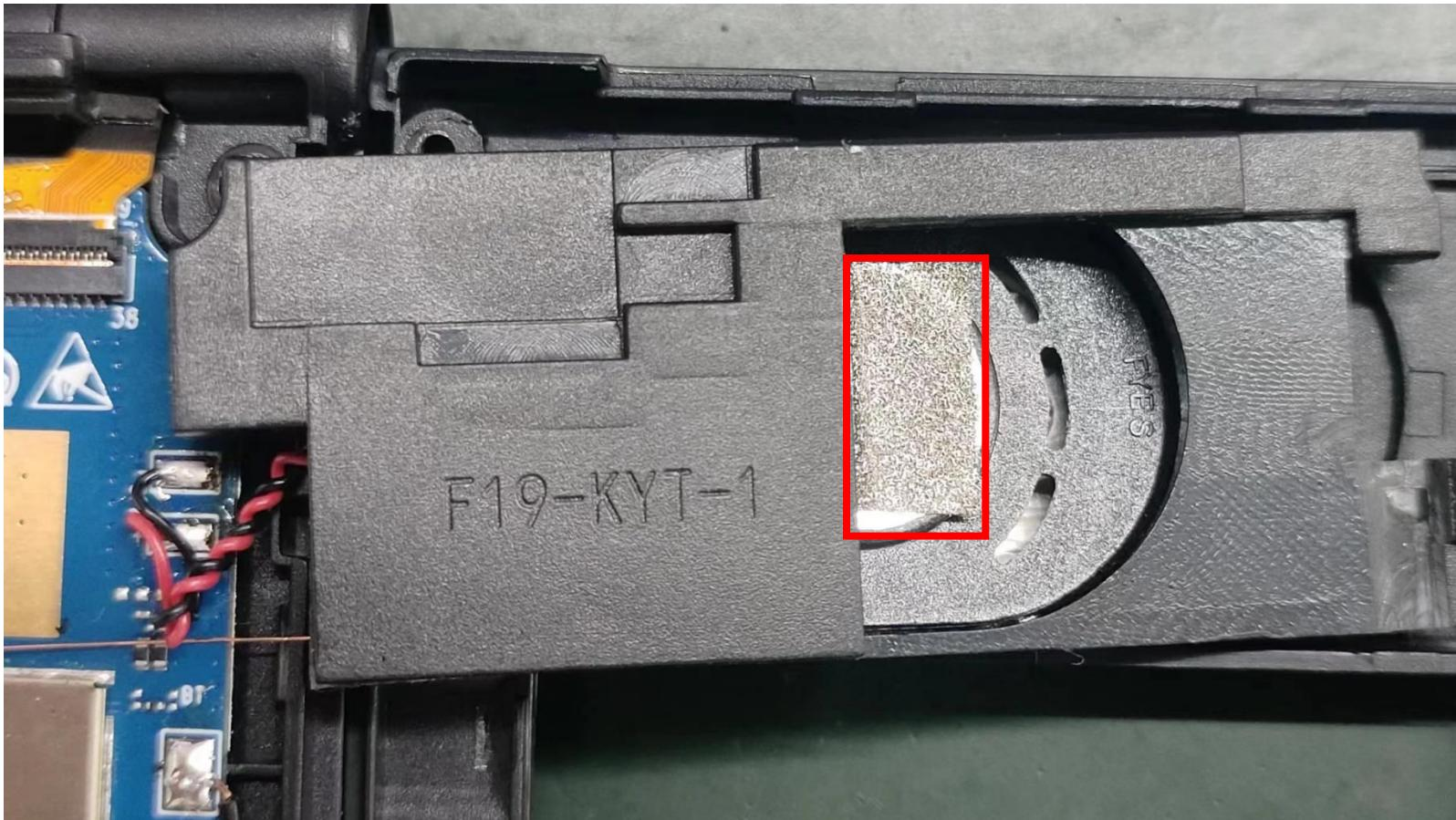
喇叭的磁钢用导电泡棉接地
