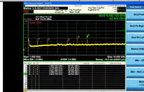
Mod: OFDM, Mode 146, 926.8MHz (1-10GHz) Peak
